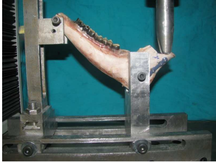
Şekil 3.13: Deney düzeneğine sabitlenen hemimandibula
