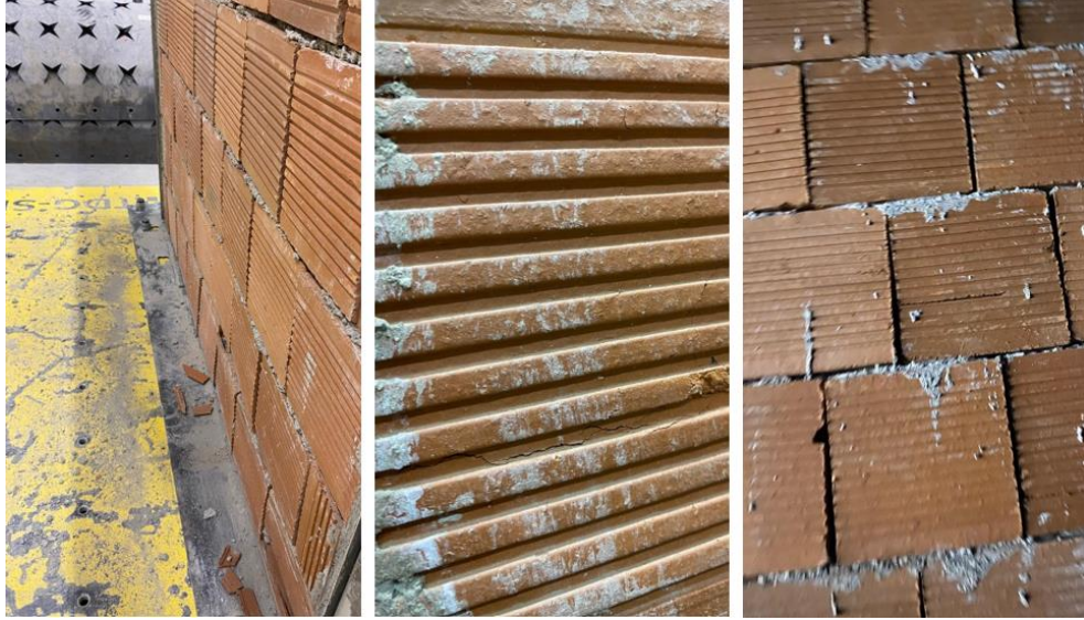
Şekil 87. Düzlem dışı durumda EDGH modelinde oluşan hasarlar
