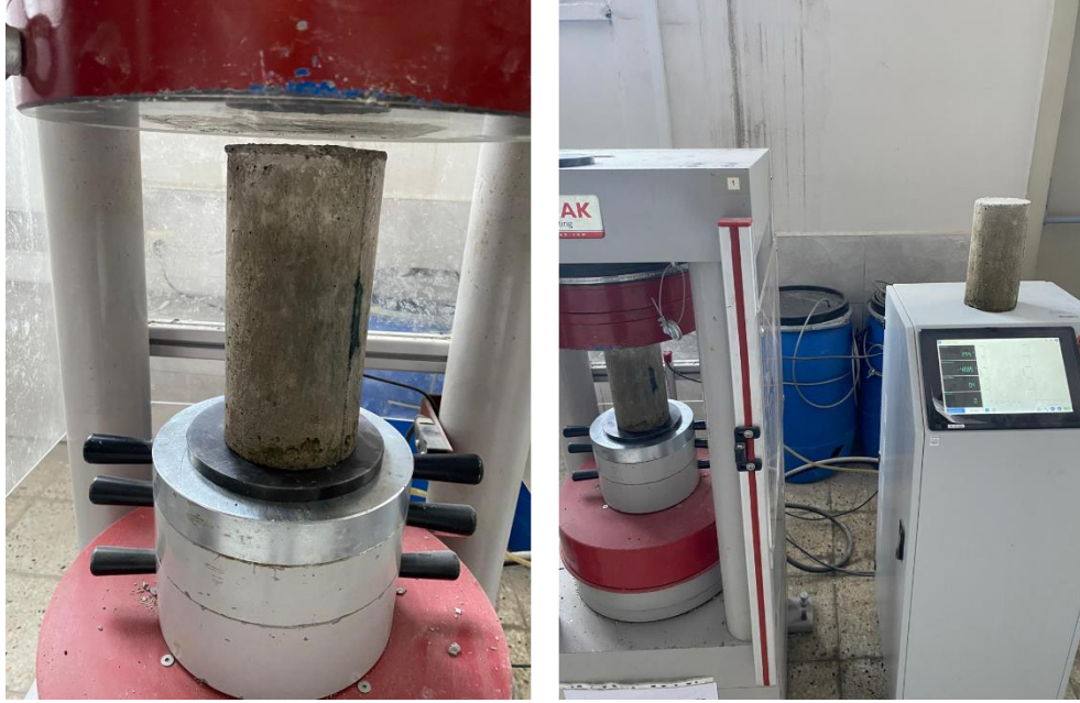
Şekil 25. Sertleşmiş beton deneyleri
