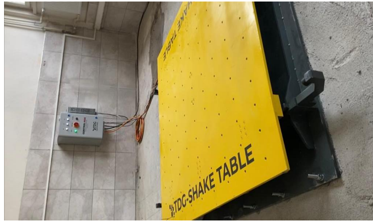
Şekil 11. Deneylerde kullanılan sarsma tablası
