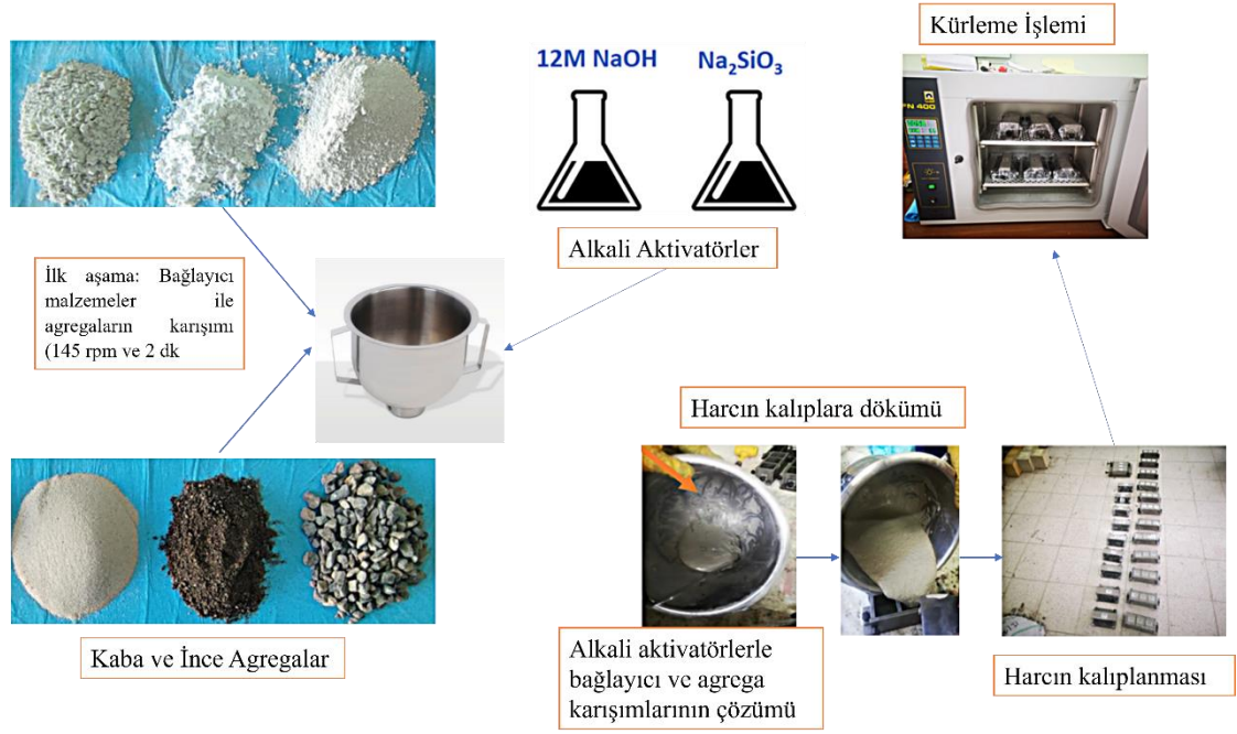
Şekil 9. Geopolimer harçların üretim aşamaları (Öz vd. 2022)
