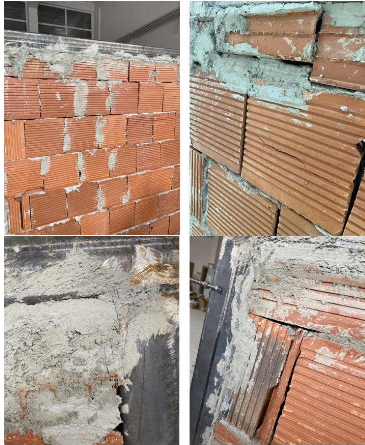
Şekil 80. Düzlem içi durumda RBGBH modelinde oluşan hasarlar
