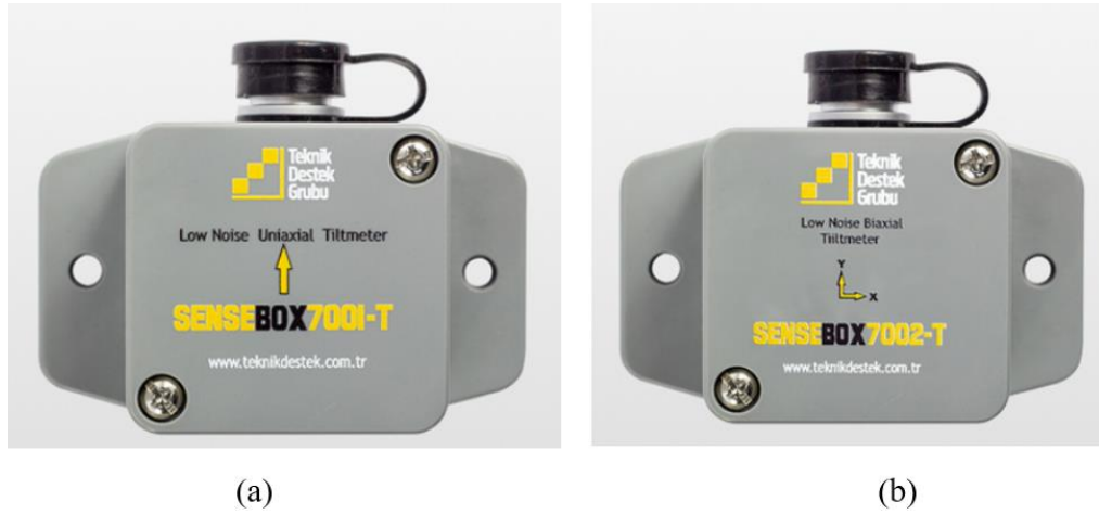
Şekil 14. İvme ölçerler; a) tek eksenli ivmeölçer, b) iki eksenli ivmeölçer
