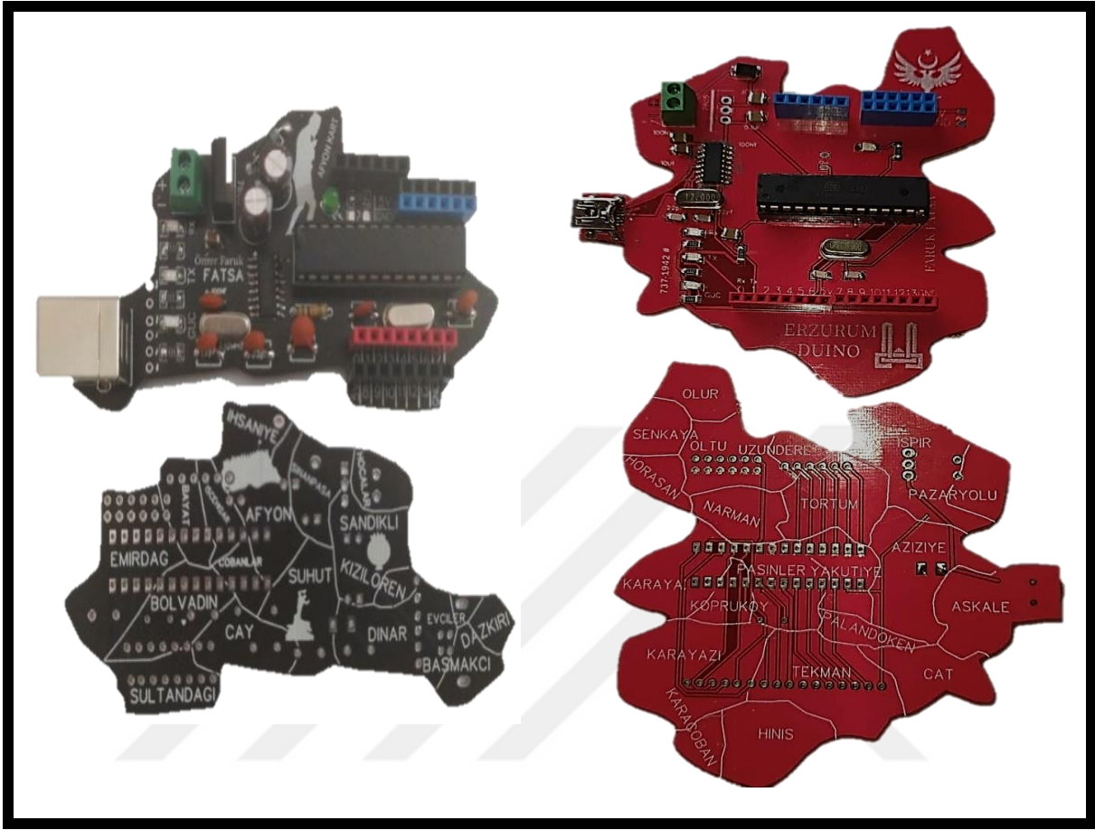
Şekil 15. Araştırmacı Tarafından Afyon ve Erzurum için Geliştirilmiş Klon Arduino Modelleri
