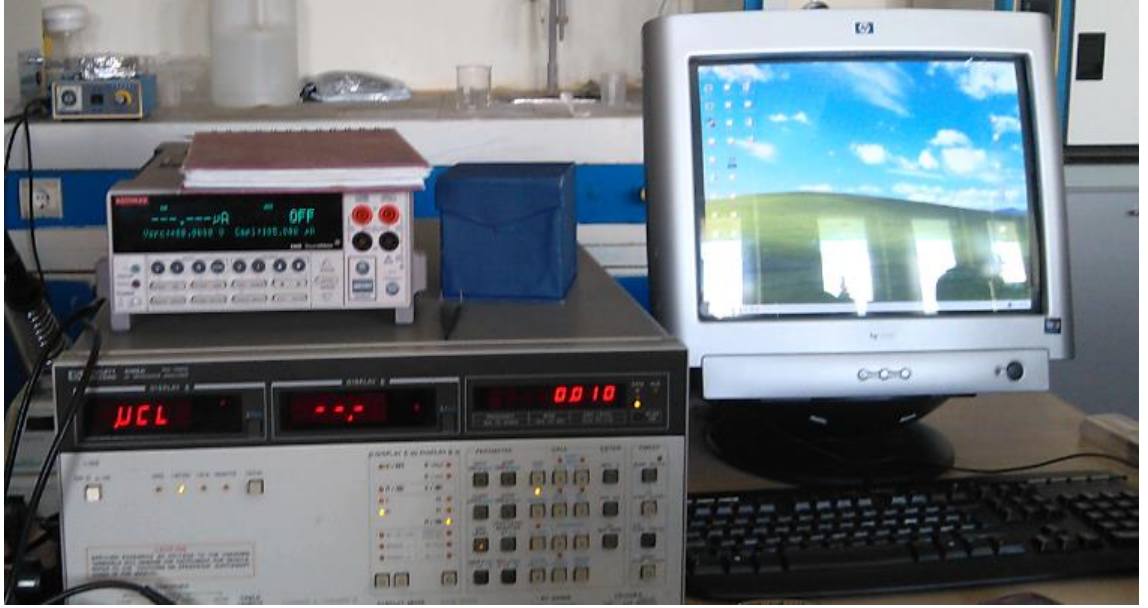
Şekil 3.8. Akım-voltaj ve kapasite-voltaj ölçüm sistemi
