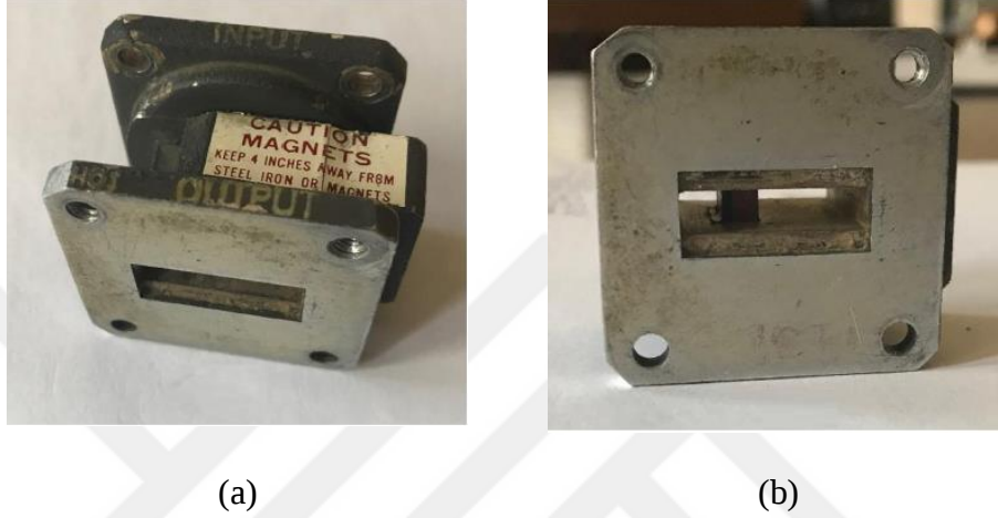
Şekil 22. Ölçümlerde kullanılan ferrit yüklü dalga kılavuzu mikrodalga faz kaydırıcının fotoğrafları.
