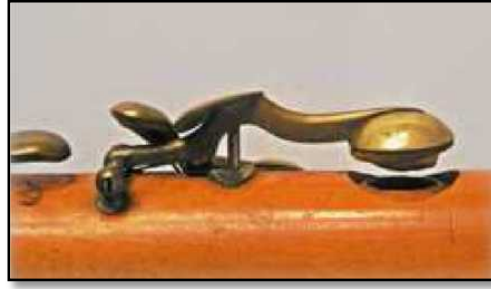
Şekil 1.5. Müller'in Buluşu Olan Deri Pedlerle Kapanmış Bir Anahtar Örneği
