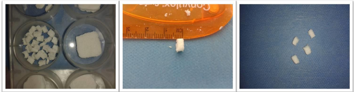
Şekil 3.3. BN/HA emdirilmiş PLGA scaffoldların hazırlanması
