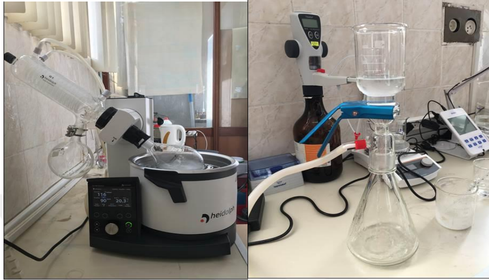
Şekil 20. (a) Rotary evaporasyon sistemi; (b) Vakumlu filtrasyon düzeneği
