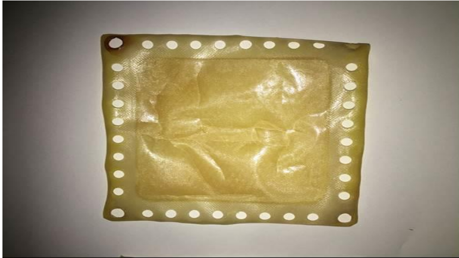
Şekil 35. Uzun kullanımlardan sonra bipolar membranlarda oluşan çatlaklar
