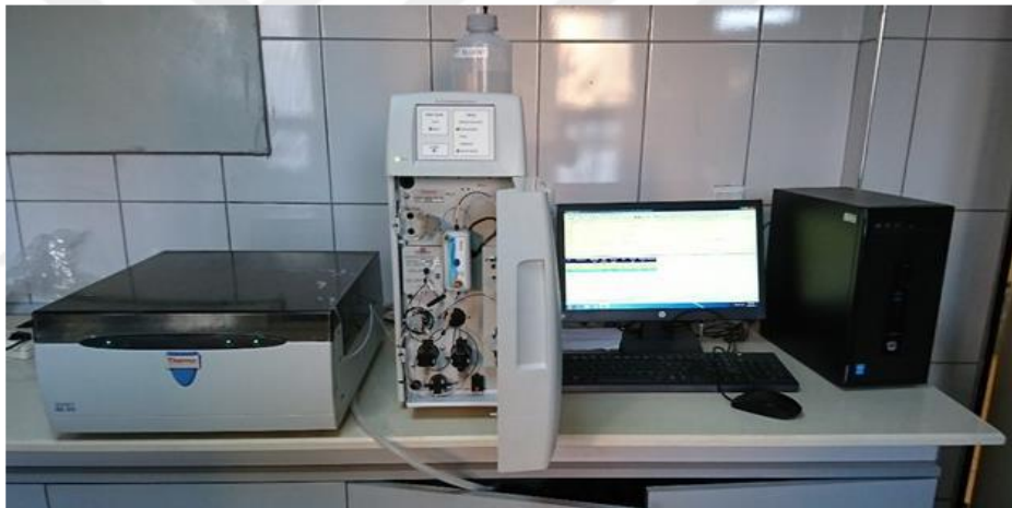
Şekil 22. Anyon analizi için iyon kromatografi cihazı (Thermo Dionex ICS 3000)
