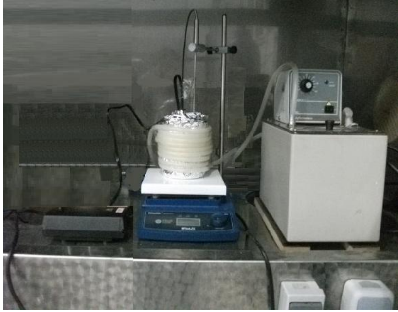
Şekil 4.42. UV denemelerinde kullanılan deney düzeneği
