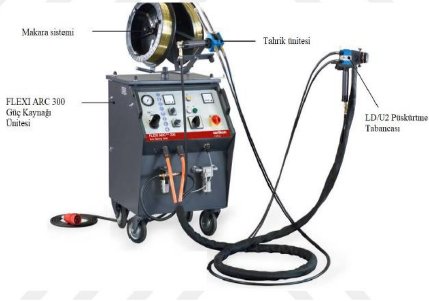
Şekil 18. Elektrik ark sprej kaplama sistem ünitesi (Çatar 2019)
