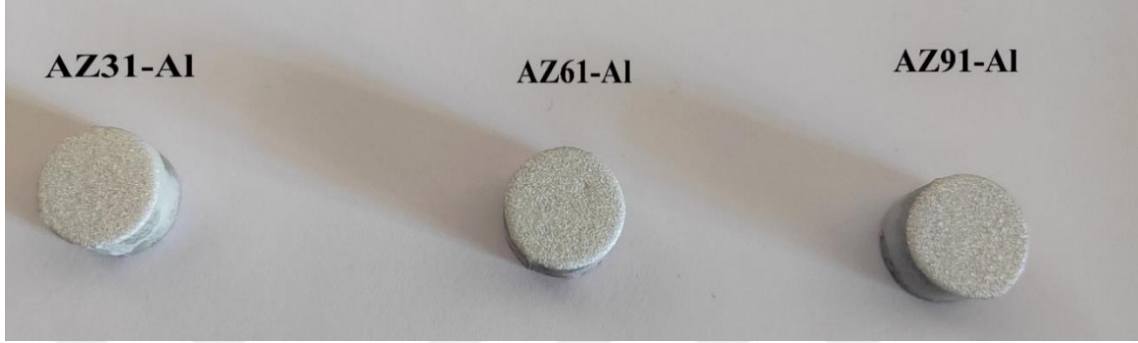
Şekil 21. Elektrik ark sprey kaplama yöntemiyle Al kaplanan numunelerin yüzey görüntüleri
