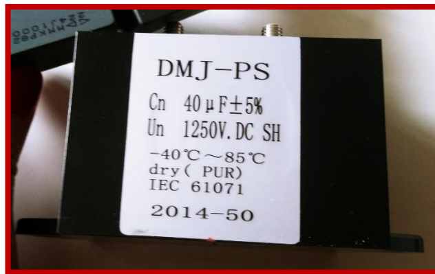
Şekil 3.7. Gerilim katlayıcı devrede kullanılan kondansatör C_n=40 \mu , U_n=1250 V
