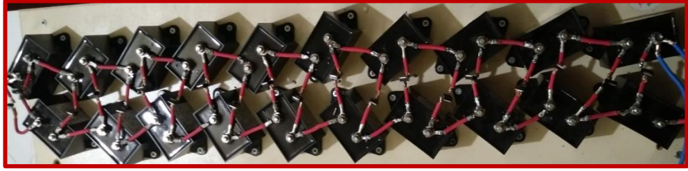
Şekil 4.3. Gerilim katlayıcı devre deney düzeneği
