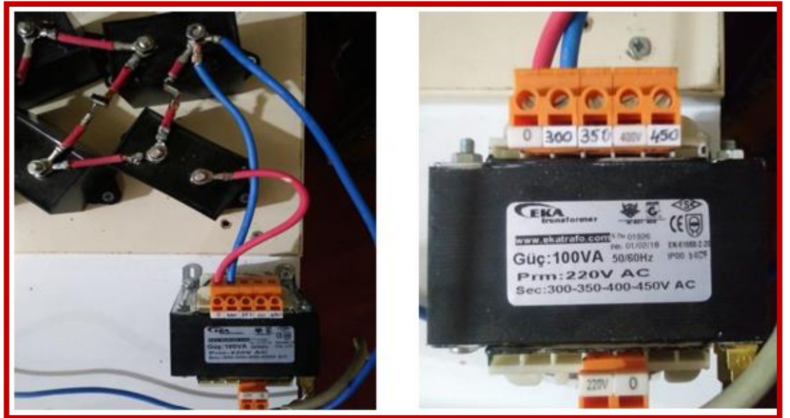
Şekil 4.2. Deney düzeneği trafo bağlantıları
