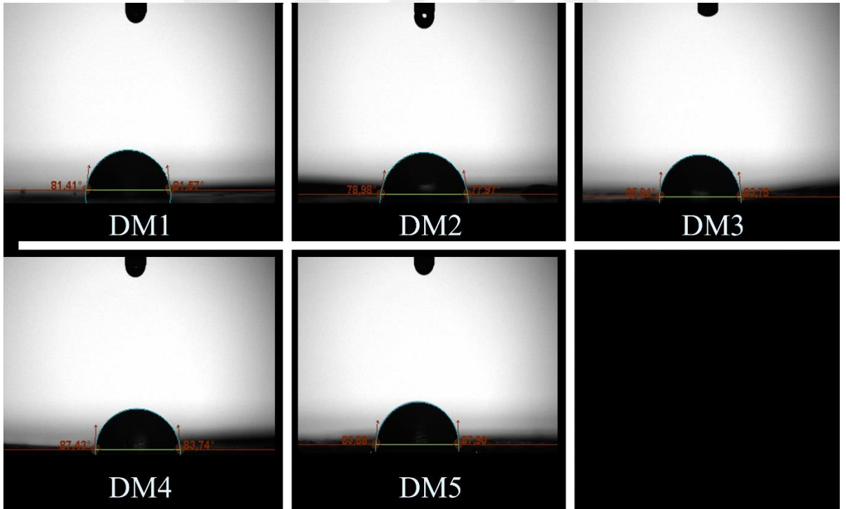
Şekil 25. Membranların alt yüzeyleri için gerçekleştirilen temas açısı ölçümlerinin ekran görüntüleri
