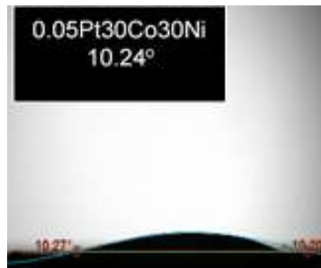
Şekil 89. 30 saniye süre ile kobalt ve nikel saçıtırma yapılmış numune temas açısı
