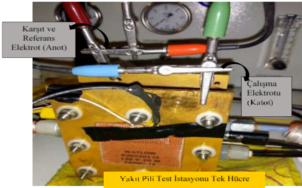
Şekil 33. İn-situ çevrimsel voltametri laboratuvar uygulaması.
