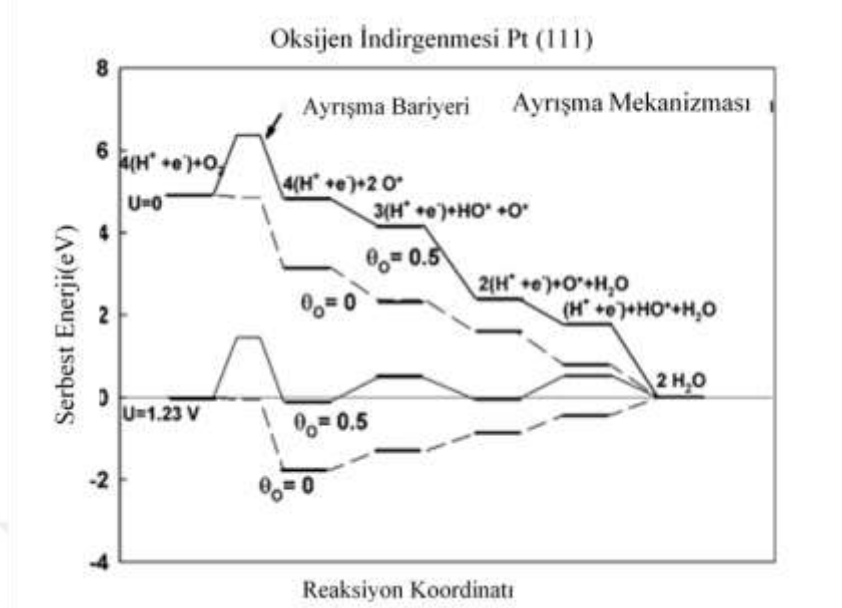
Şekil 14. İki farklı potansiyelde ve iki farklı oksijen ortamında oksijen indirgenmesi için serbest enerji diyagramı (Nørskov et al. 2004).
