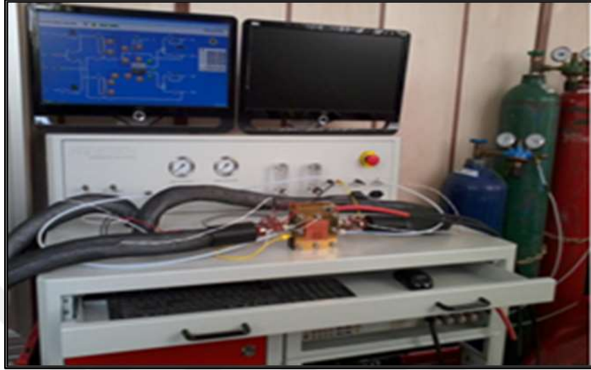
Şekil 37. Yakıt pili test istasyonu
