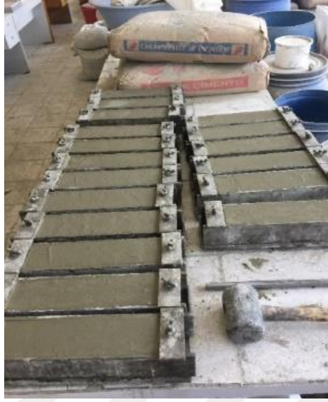
Şekil 4.10. Eğilme deneyi için hazırlanan beton numuneleri
