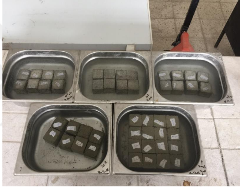
Şekil 4.3. Ön deneme harç numunelerinin hazırlanıp kür edilmesi
