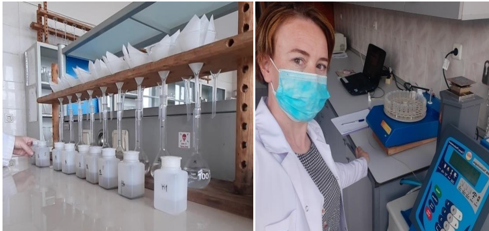
Şekil 22. KDK ve değişebilir katyon analiz süreci ve fleymfotometrede okuma
