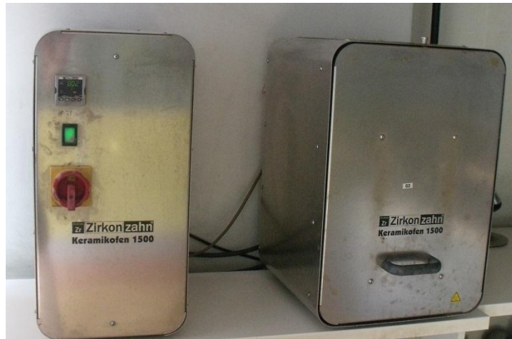
Şekil 3.6. Örneklerin Zirkonzahn Keramikofen 1500 sinterleme fırınında sinterlenmesi
