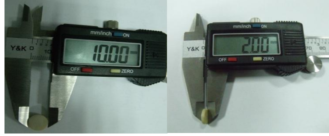
Şekil 3.1. Örneklerin dijital kumpasla ölçülmesi
