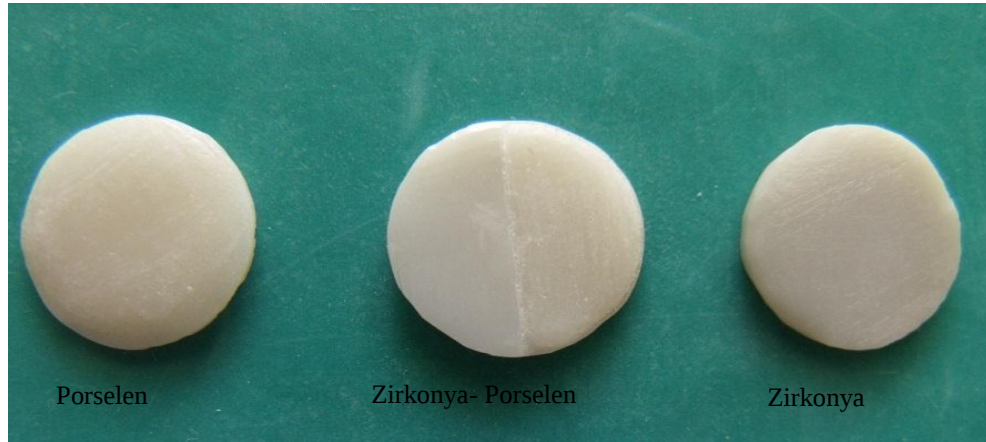
Şekil 3.2. Tamir uygulamasından önce; porselen, zirkonya-porselen ve zirkonya örnekler
