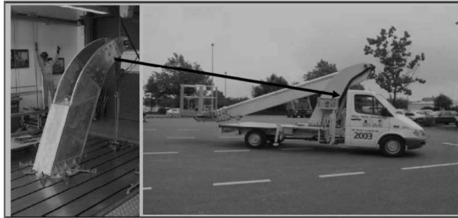
Şekil 2.18. Alüminyum hafif-ağırlıklı sandviç panel örneği
