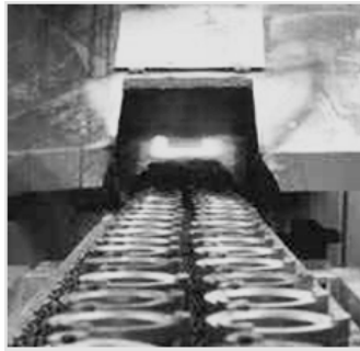
Şekil 1.7. Toz metalurjisi ile üretimde sinterleme
