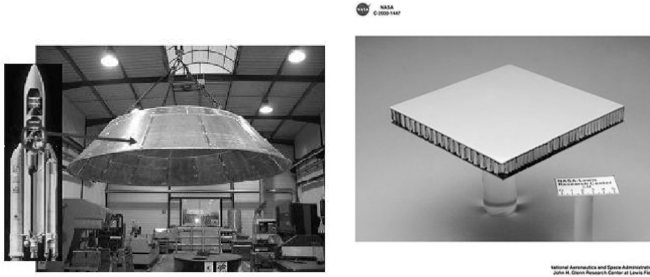
Şekil 2.17. Sandviç köpük panelden (AFS) yapılmış Ariane5 roket konisi
