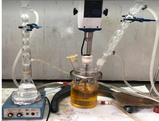
Şekil 1. Transesterifikasyon yöntemi deney düzeneği
