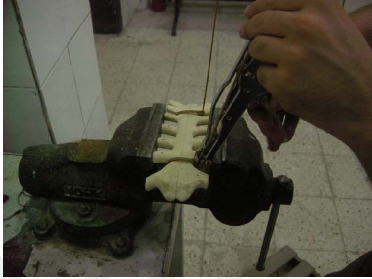
Şekil 3.13. PEEK bant yönteminin uygulanışı
