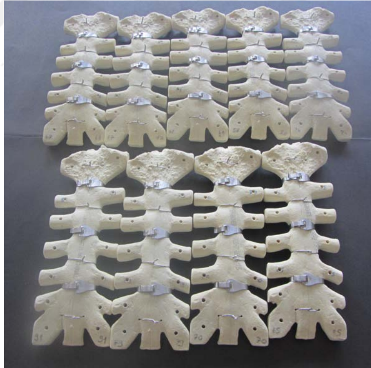
Şekil 3.11. Üç çelik bant ve dört tane tel kullanılarak sternumun kapatılması
