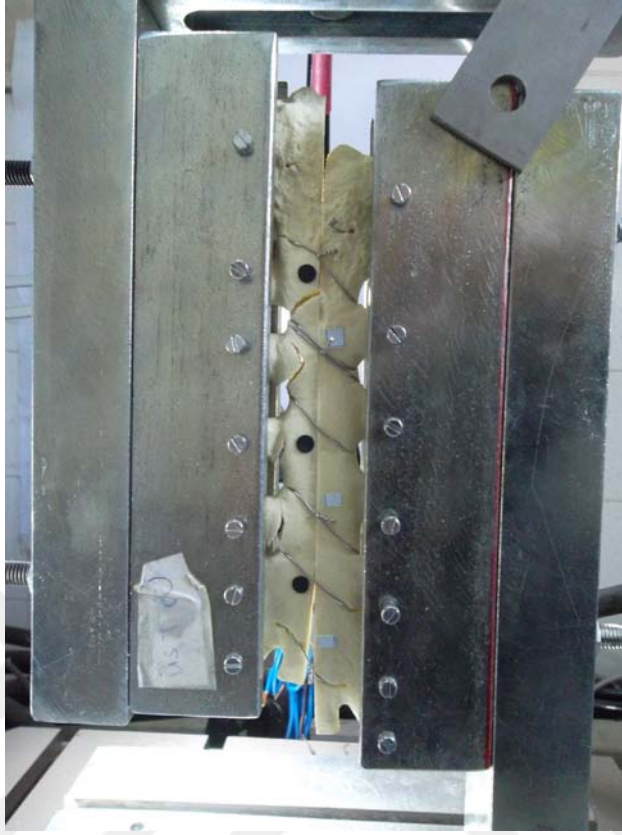
Şekil 4.27. Çelik tellerle figür-8 yönteminin boyuna kesme yükü etkisinde göçme mekanizması
