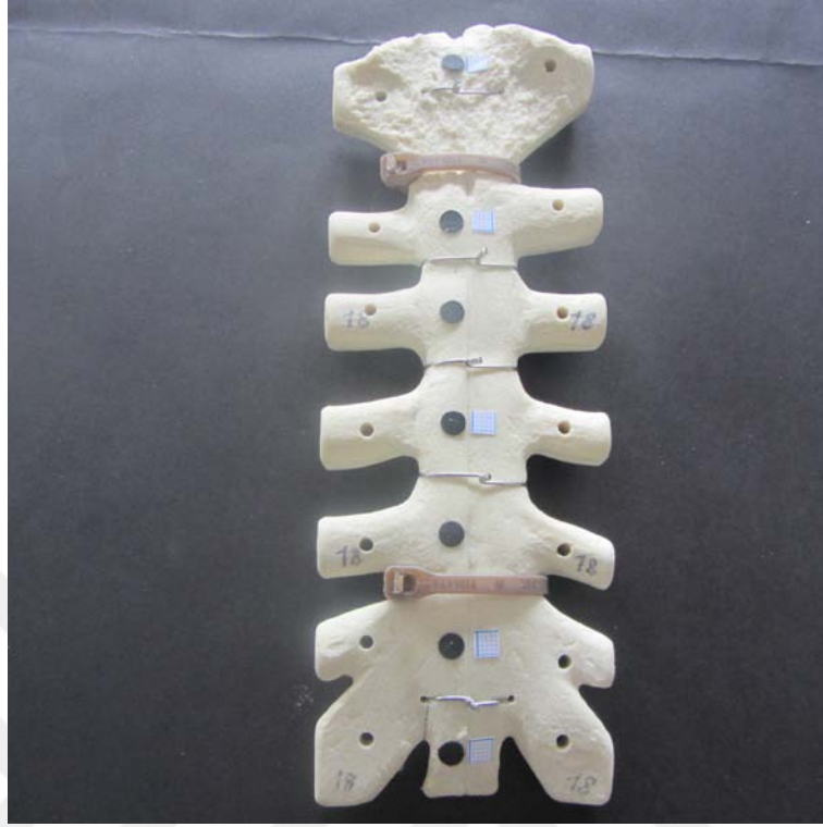
Şekil 3.15. İki tane PEEK bant ve beş tane tel kullanılarak sternumun kapatılması
