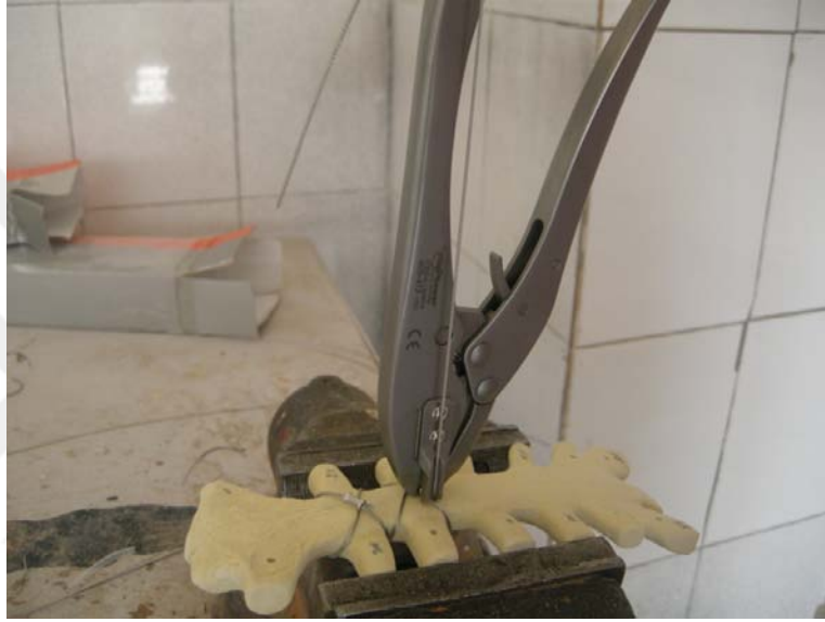
Şekil 3.8. Çelik kablolarla figür-8 yönteminin uygulanışı
