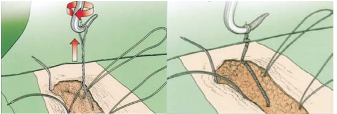
Şekil 2.14. Çift telin kanca ile bükülmesi ve yeterli bükülmede telde oluşan burkulma (Kiessling et al. 2005)
