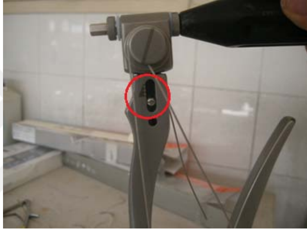
Şekil 4.79. Çelik kabloların montaj enstrümanının üzerindeki gerilme göstergesi
