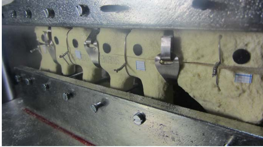
Şekil 4.9. Üç çelik bant yönteminin yanal ayrılma yükü etkisinde göçme mekanizması
