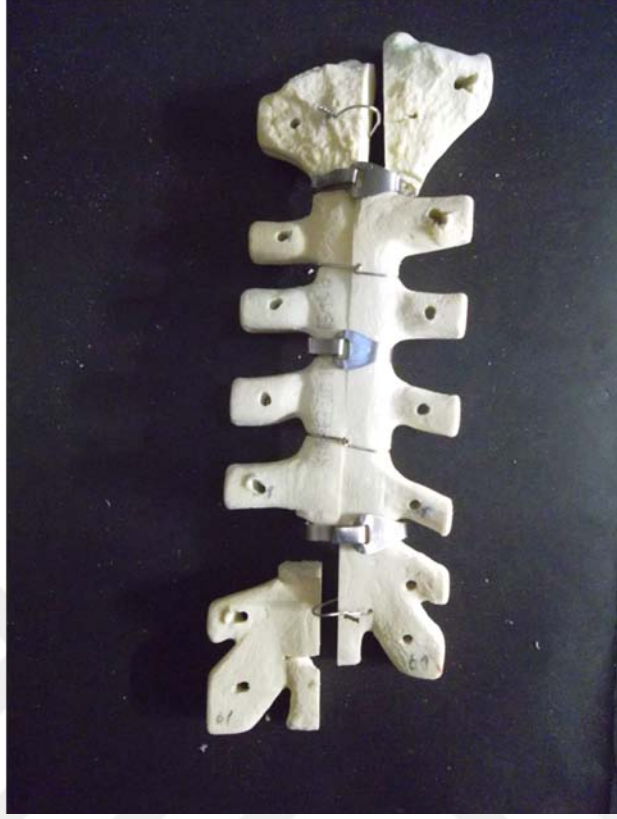
Şekil 4.57. Üç çelik bant yönteminin enine kesme yükü etkisinde göçme mekanizması
