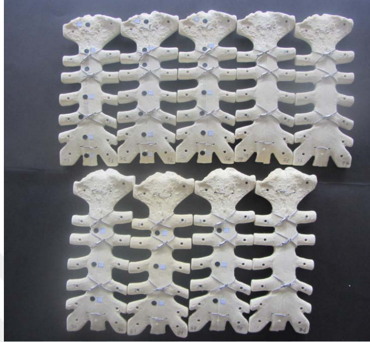
Şekil 3.9. Çelik kablolarla yapılan figür-8 yöntemiyle kapatılmış sternumlar
