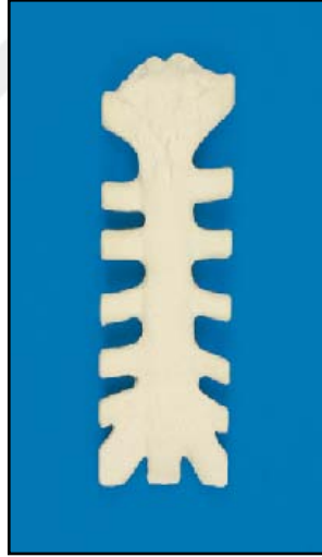
Şekil 3.1. Poliüretandan üretilen yapay sternum modeli
