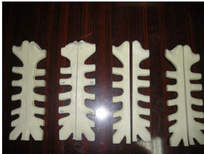
Şekil 3.4. Medyan sternotomi uygulanmış sternum modelleri
