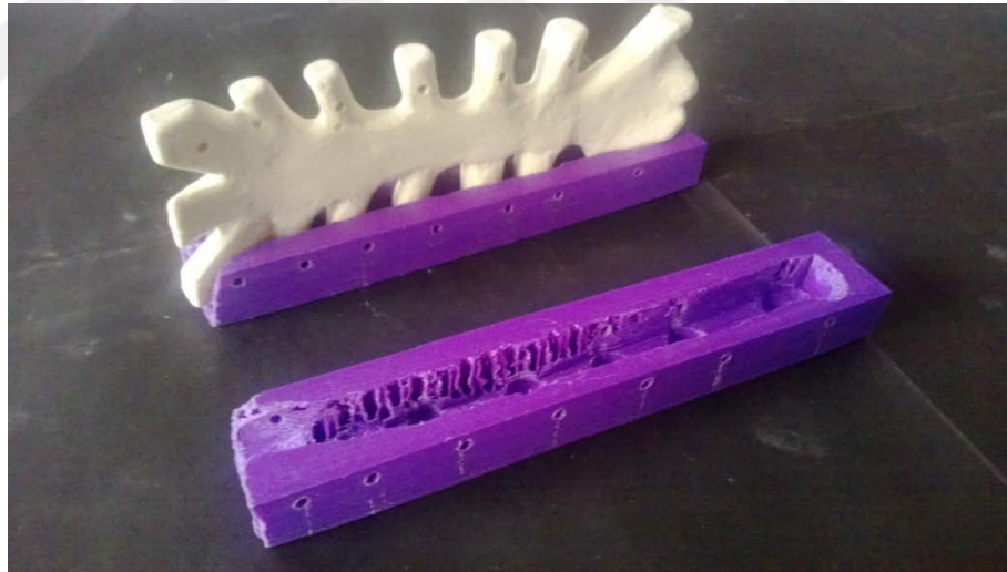
Şekil 3.20. Sternum modellerinin delinmesinde kullanılan kalıplar
