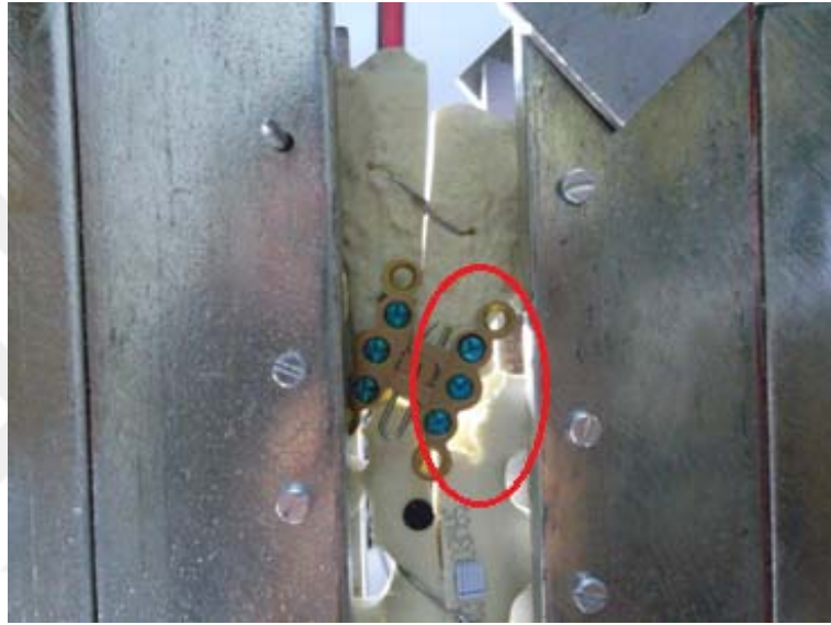
Şekil 4.83. Boyuna kesme yüklemesinde plâk vidalarının sternumu kesmesi
