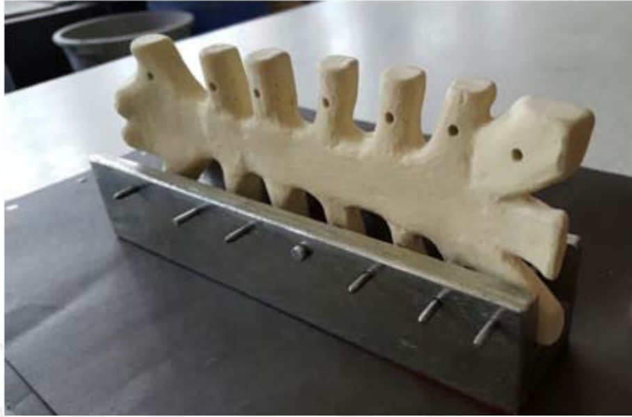
Şekil 3.21. Sternum modellerinin çenelere vidalarla sabitlenmesi
