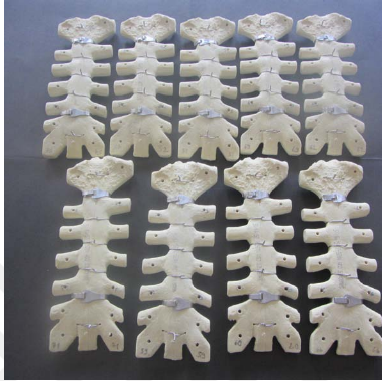
Şekil 3.12. İki çelik bant ve beş tane tel kullanılarak sternumun kapatılması
