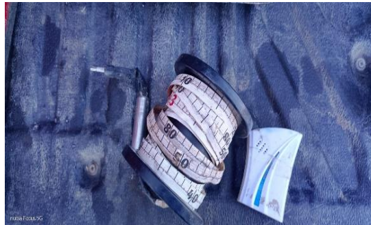
Şekil 10. Araştırma alanında tabansuyunu ölçen zil düzenli şeritmetre (Özgün, Şeyma ÖZGENEL)
