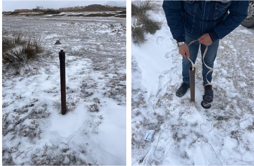
Şekil 11. Araştırma alanında tabansuyu gözlem kuyusu (Özgün, Şeyma ÖZGENEL)
