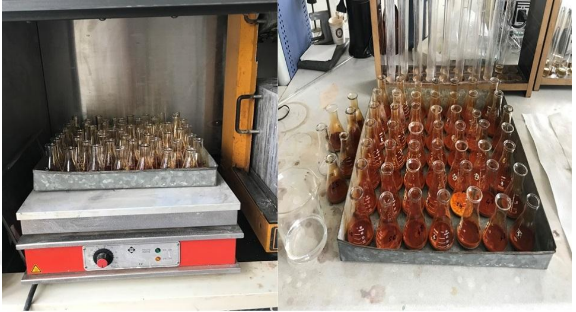
Şekil 3.4. Nitrik-Perklorik asit yaş yakma yöntemi ile örneklerinin hazırlanması
