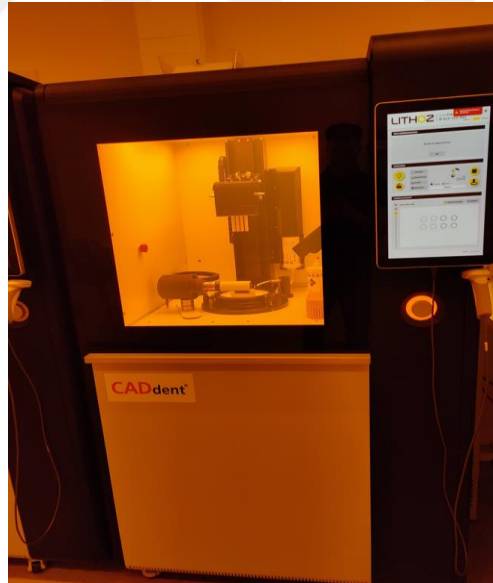
Şekil 3.4. 3D yazıcı ile zirkonya örneklerin üretimi
