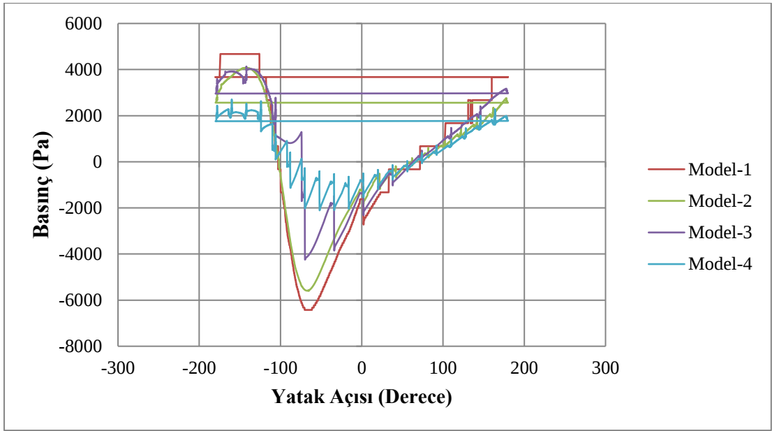
Şekil 27. Model-1, model-2, model-3 ve model-4 sıvı film basınç dağılımı grafiği
