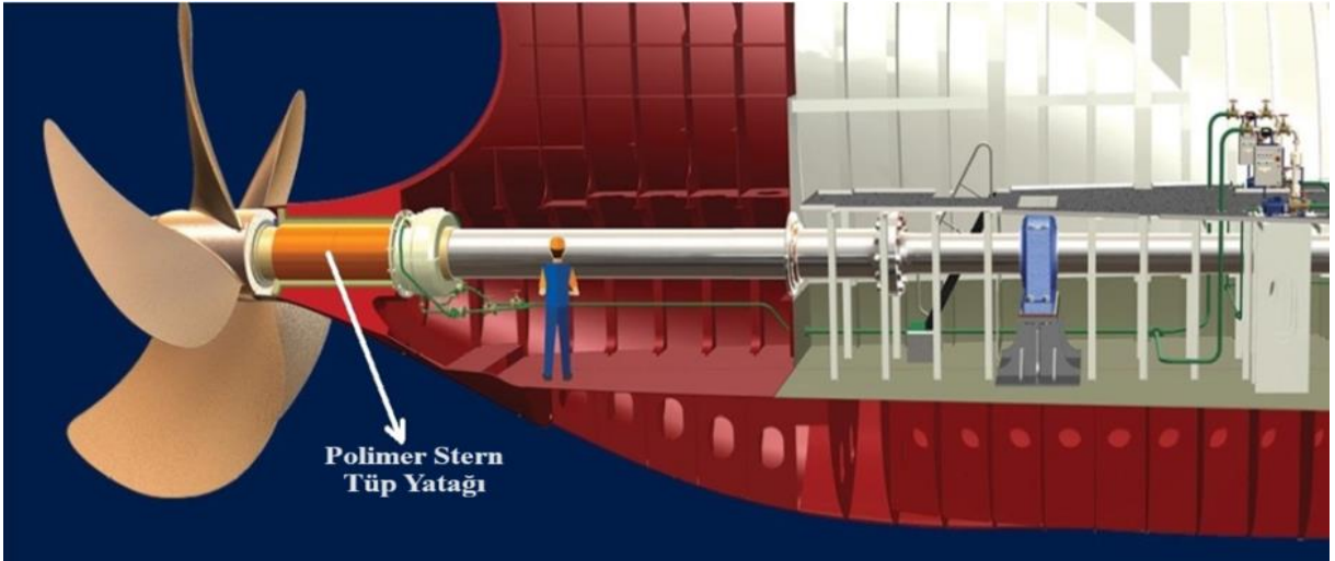
Şekil 17. Suyla yağlamalı polimer gemi stern tüp yatağı (Carter 2004)
