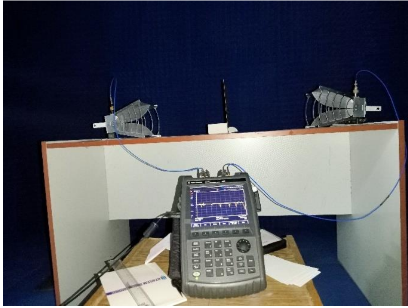
Şekil 23. Gerçek zamanlı ölçümler için yankısız oda içerisinde oluşturulan deneysel ölçüm düzeneği
