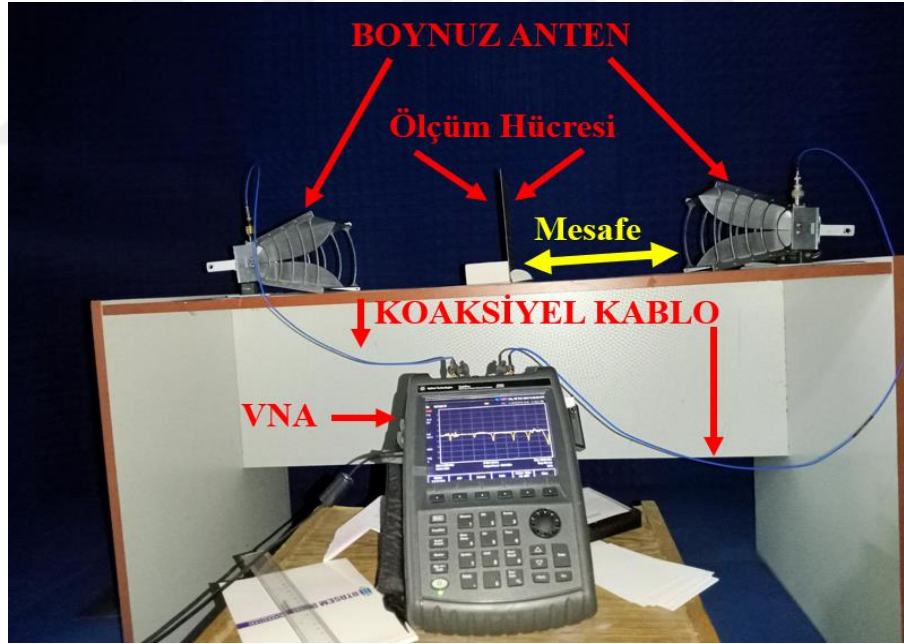
Şekil 10. Yankısız oda koşullarında gerçekleştirilen ölçüm düzeneği
