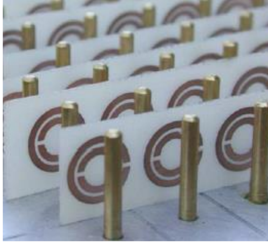
Şekil 4. İlk üretilen, eş zamanlı negatif elektrik ve manyetik parametreye sahip metamalzeme (Smith, Padilla, et al. 2000)
