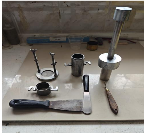
Şekil 20. Kompaksiyon deney aleti (Sridhara 2005)
