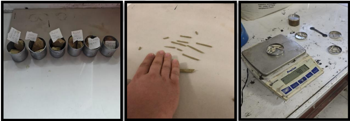
Şekil 27. Plastik limit deneyine ait görseller
