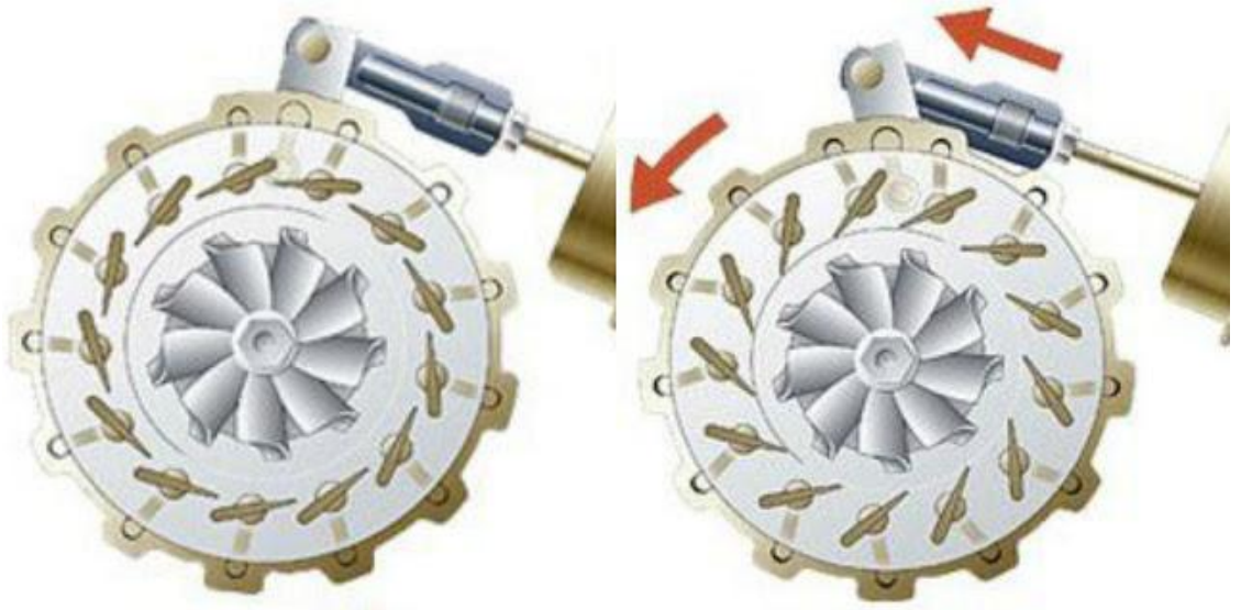
Şekil 2.23. Değişken Kanatçıklı kontrol mekanizması (Anonim, 2019c)
