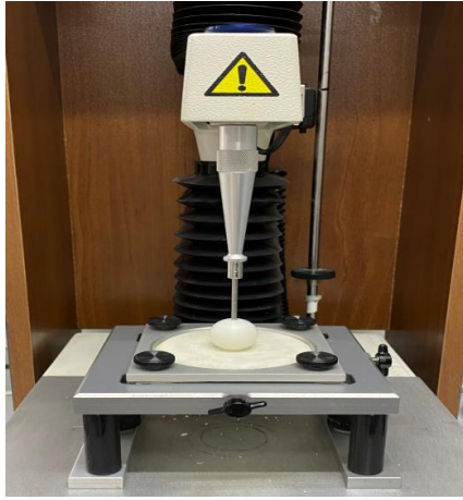
Şekil 4. Yufka örneklerinde yapılan Gerilim-Gevşeme testi
