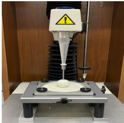
Şekil 1. Yufka örneklerinde yapılan germe testi
