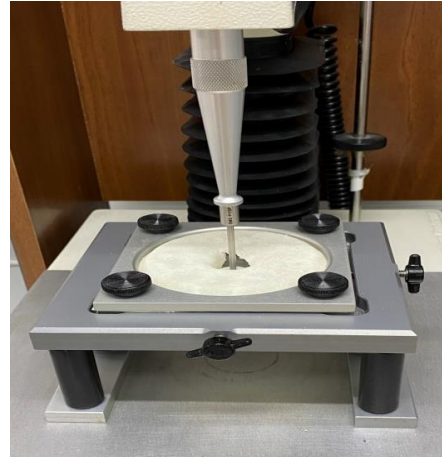
Şekil 4. Yufka örneklerinde yapılan Gerilim-Gevşeme testi
