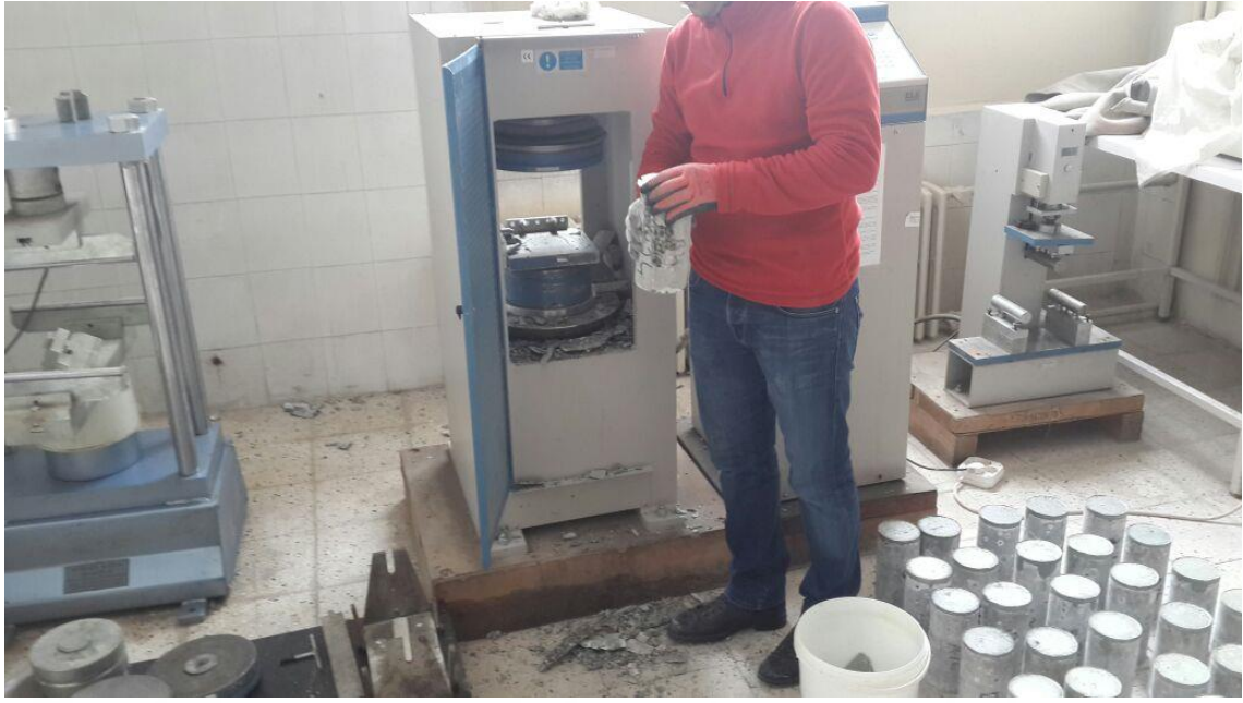
Şekil 21. Silindir numunenin basınç testleri sonucu görünümü
