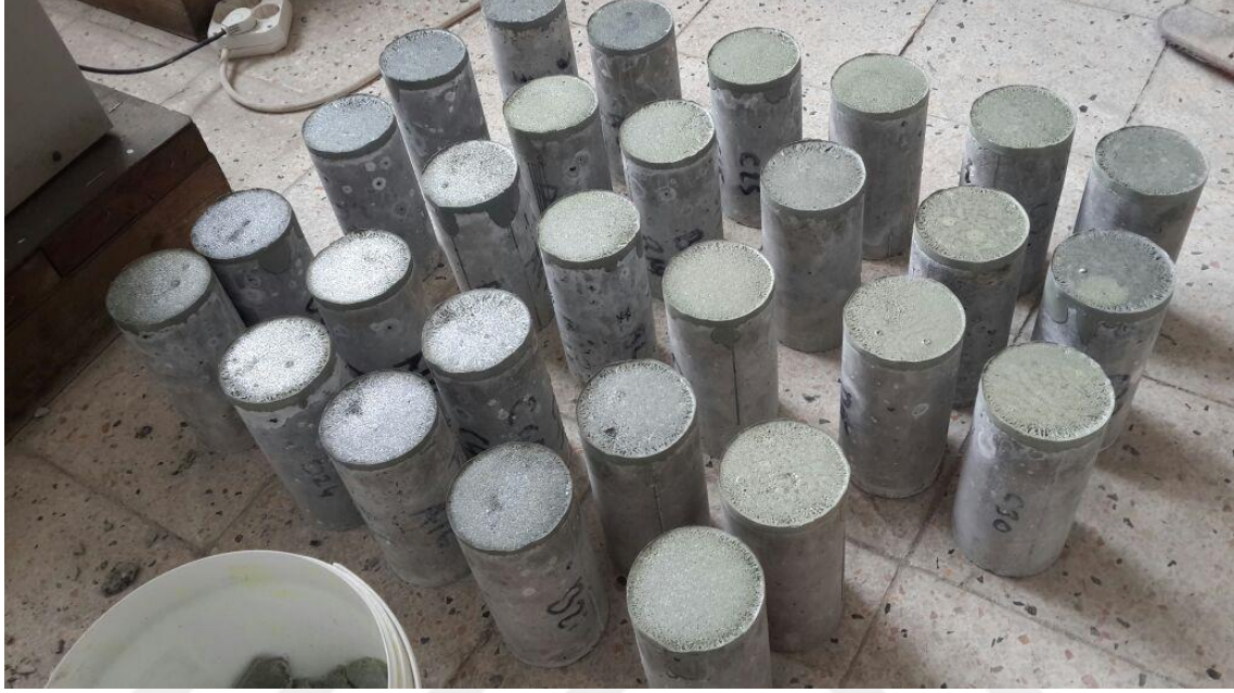
Şekil 20. Silindir numunelerin sülfat çözeltisinde bekletildikten sonraki fiziksel görünümü
