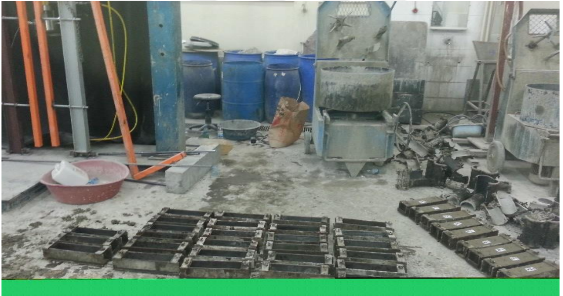
Şekil 5. Dikdörtgen beton kalıplar
