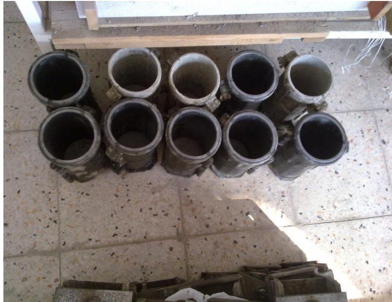
Şekil 3.3. Beton numune kalıpları
