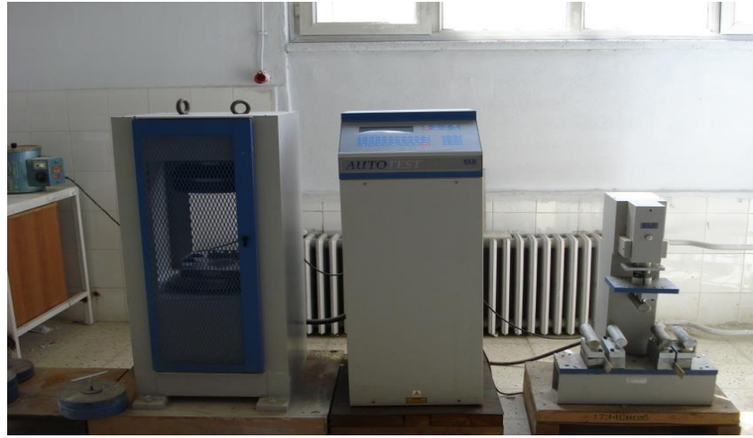
Şekil 3.4. Beton numunelerin kırıldığı pres
