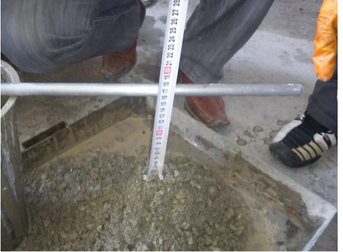
Şekil 3.15. Çökme değeri ölçümü
