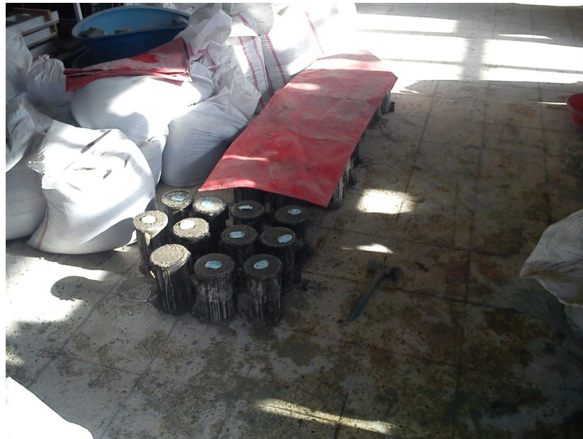
Şekil 3.17. Sertleşmiş beton deneyleri için hazırlanan numuneler
