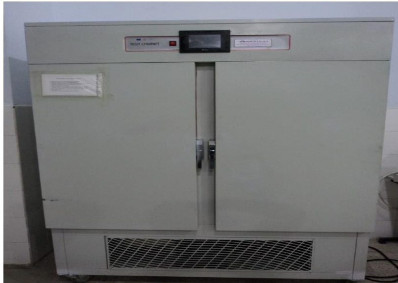
Şekil 3.14. Atmosferik buhar kürü makinesi
