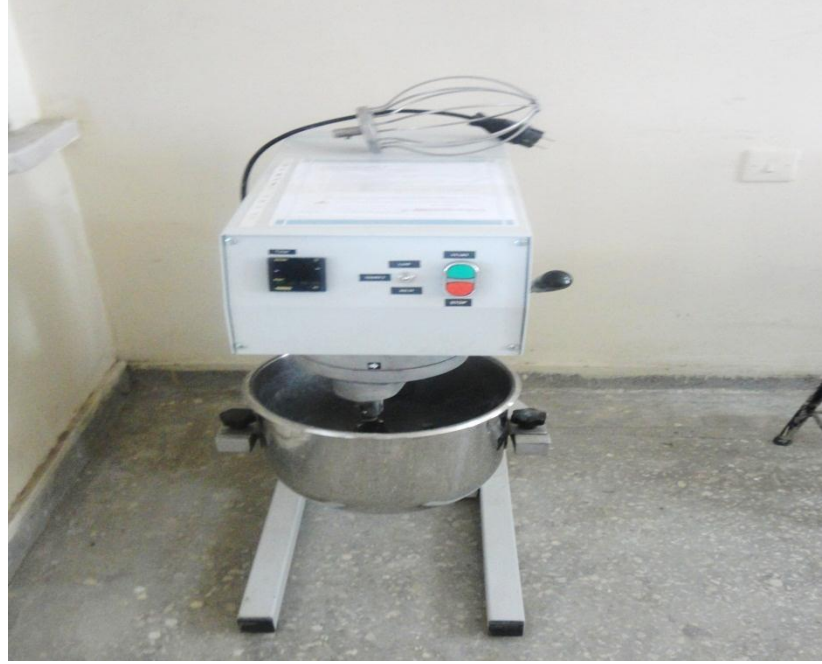
Şekil 3.5. Çimento numune harçlarının karıştırıldığı karıştırıcı
