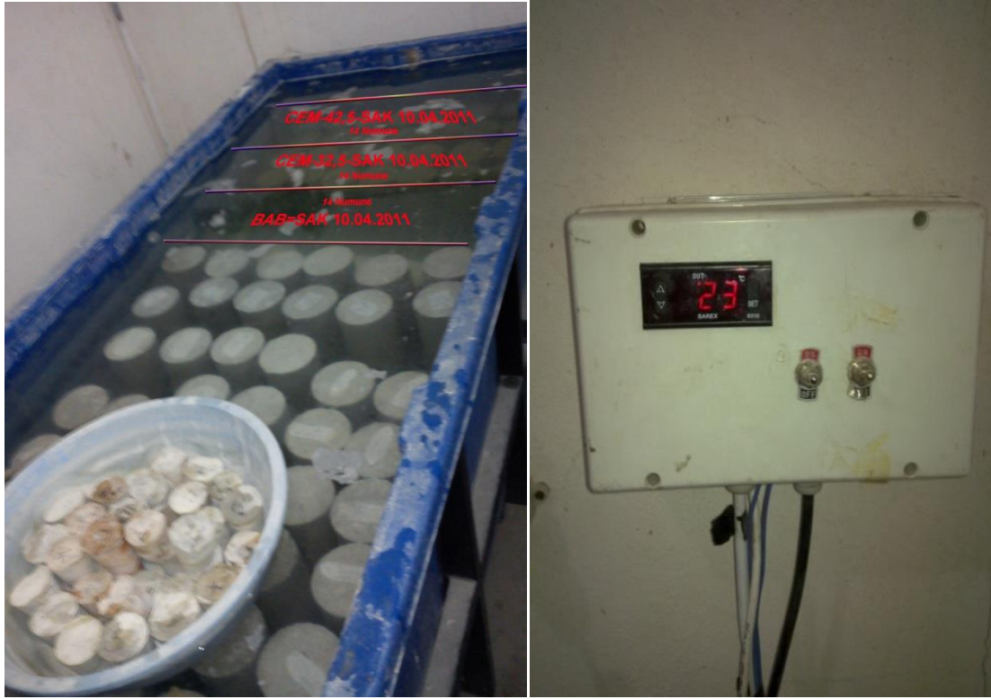
Şekil 3.16. Kür havuzu ve su kürü uygulanan numuneler
