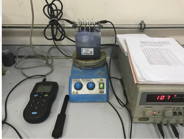
Şekil 3.2. Elektrokoagülasyon deney düzeneği
