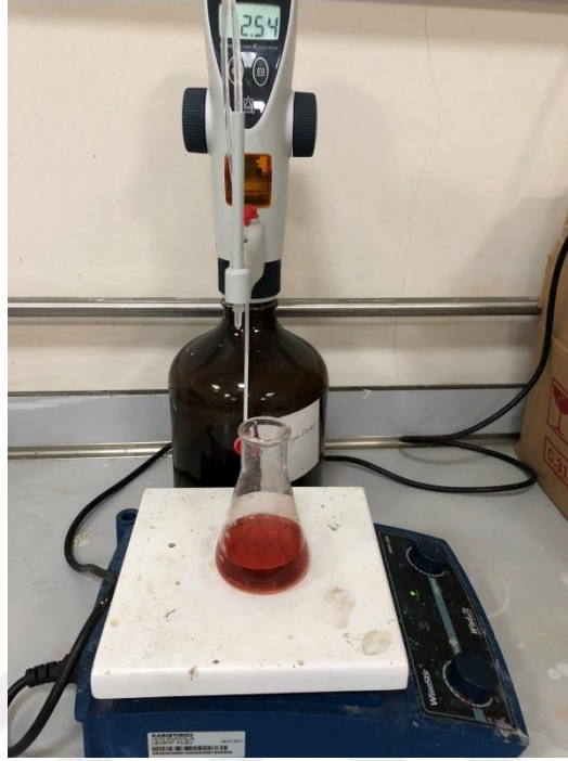
Şekil 3.4. DAS ile titrasyon sonrası elde edilen kiremit kırmızısı numune
