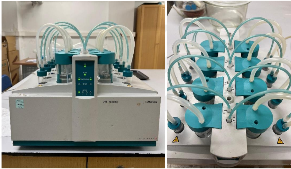
Şekil 11. Ransimat cihazının önden ve üstten gösterimi (Manual 743 Ransimat).
