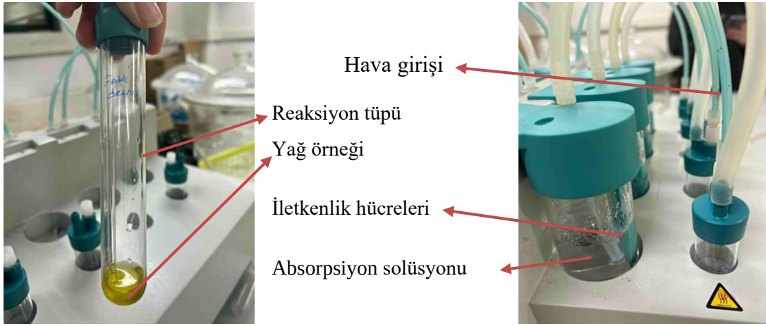
Şekil 10. Oksidatif stabilite ölçümünde kullanılan ransimat cihazının çalışma prensibinin şematik olarak gösterimi
