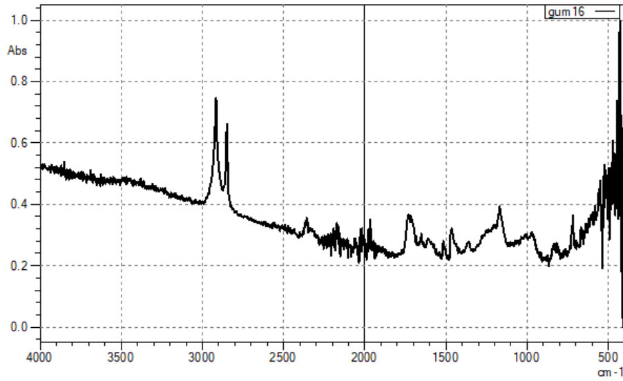
Şekil 33. Defne yaprağı örneğinin FTIR (Fourier Transform Infrared) spektrumu
