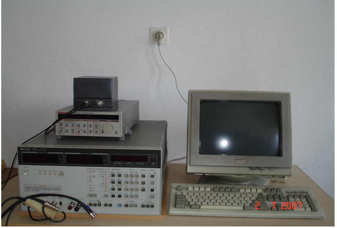
Şekil 3.3 Akım-gerilim, kapasite-gerilim ve kapasite-frekans ölçüm sistemi
