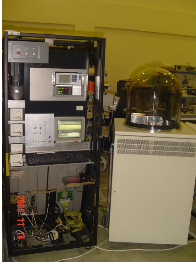
Şekil 3.1. Ölçme laboratuvarımızda mevcut buharlaştırıcı sistemimizin görünümü.
