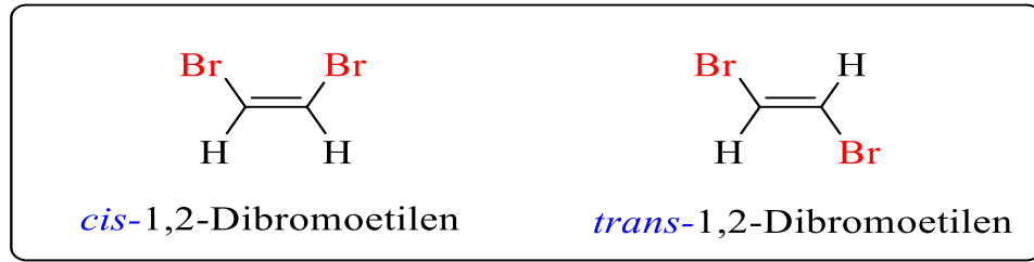
Şekil 1.3. 1,2-Dibromoetilenin cis ve trans gösterimi
