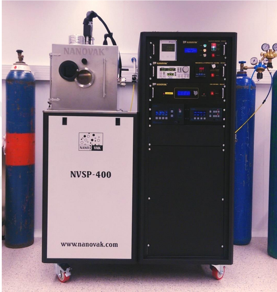
Şekil 2.12. ZnO ince filmlerini hazırlamak için kullanılan tipik bir püskürtme sistemi
