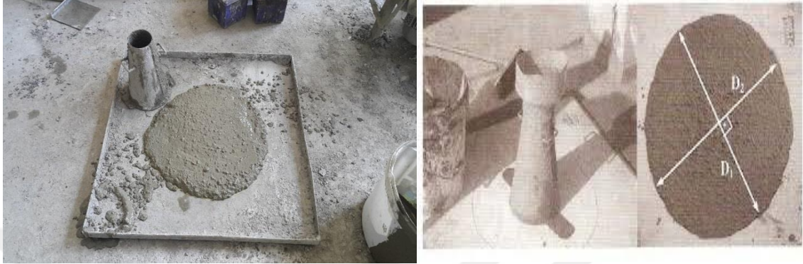
Şekil 3.14. Çökme - Yayılma deneyi
