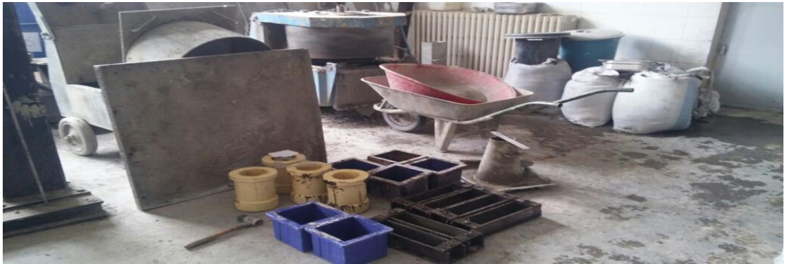
Şekil 3.6. Numune Kalıpları (a: silindir kalıp, b: prizma kalıp, c: küp kalıp)
