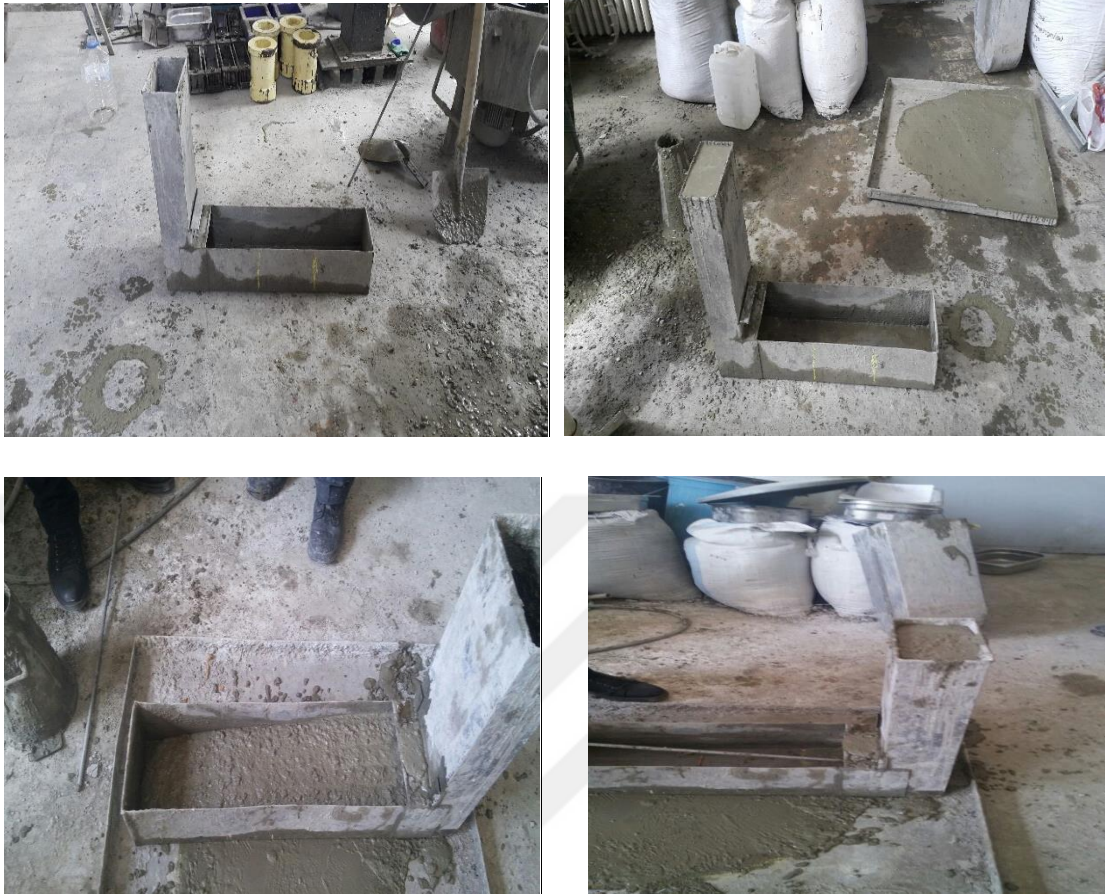
Şekil 3.16. L kutusu deneyi
