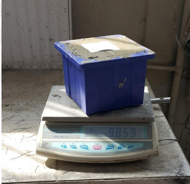
Şekil 3.12. Taze birim hacim ağırlığı deneyi
