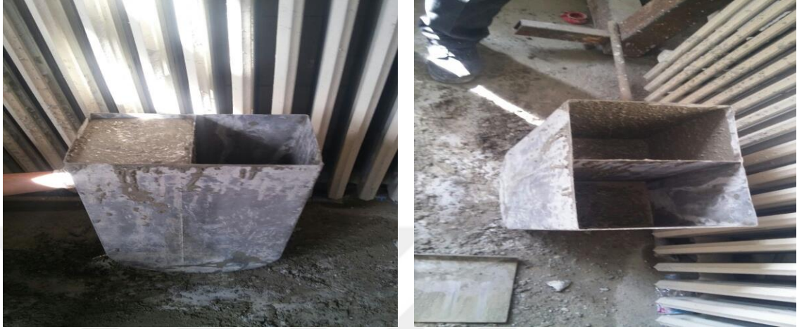
Şekil 3.17. U kutusu deneyi
