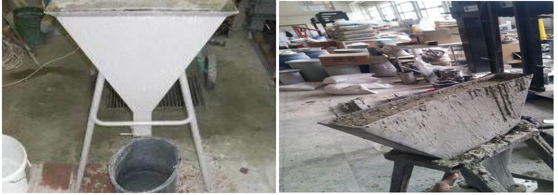
Şekil 3.15. V hunisi deneyi
