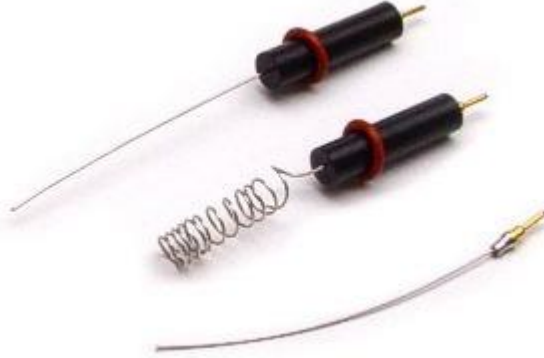
Şekil 12. Farklı şekillerdeki Pt karşıt elektrotlar
