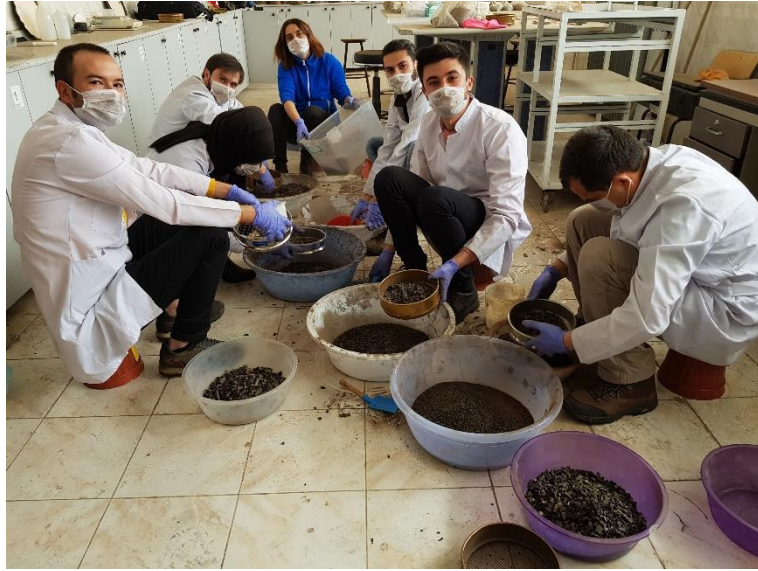
Şekil 10. Atölye atığının elekler yardımıyla ayrıştırılması
