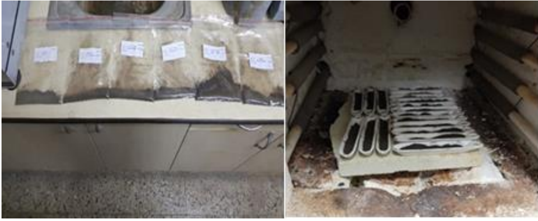
Şekil 19. Toz haline getirilmiş (soldaki) ve kül analizi gerçekleştirilecek krozeler içindeki malzeme (sağdaki)
