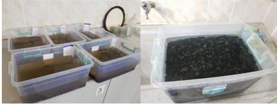
Şekil 12. Suda 24 saat bekletilen numuneler (solda) ve yıkandıktan sonra kontrol için suya bırakılan numuneler (sağda).
