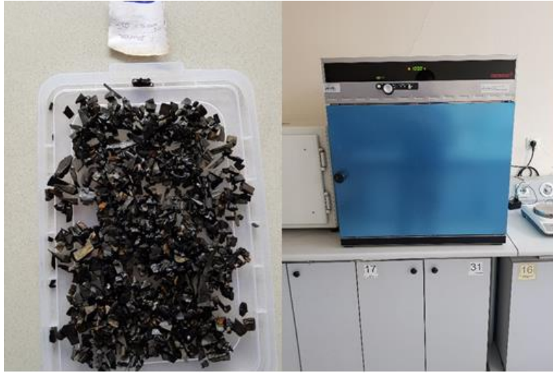
Şekil 13. Sudan çıkarılan ve yıkanan örnek numune grubu (-10+5mm) ve yıkanmış yaş malzemeleri kurutmak için kullanılan fırın.
