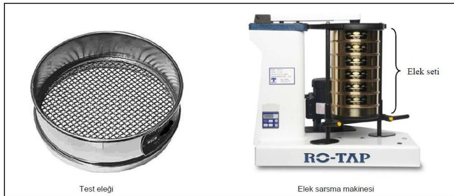
Şekil 7. Standart elek ve elek setlerini yerleştirildiği titreşimli elek makinesi
