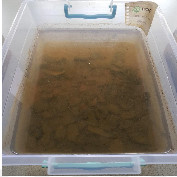
Şekil 28. 24 saat sonunda çökelen malzemenin görüntüsü (kum ve kil taşı gibi yabancı inorganik maddeler)
