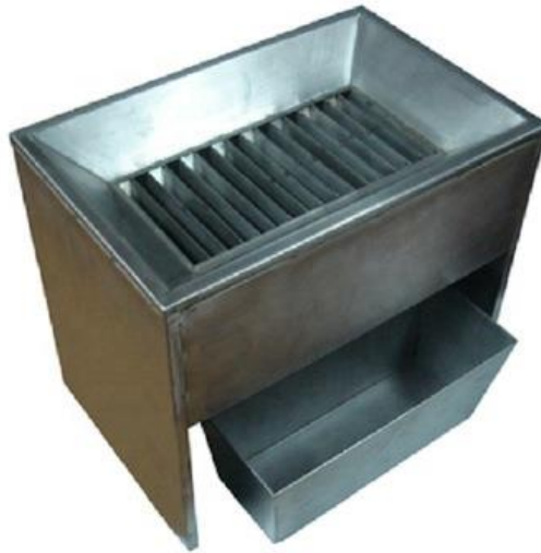
Şekil 16. Temsili numune alınması için kullanılan ayırıcı
