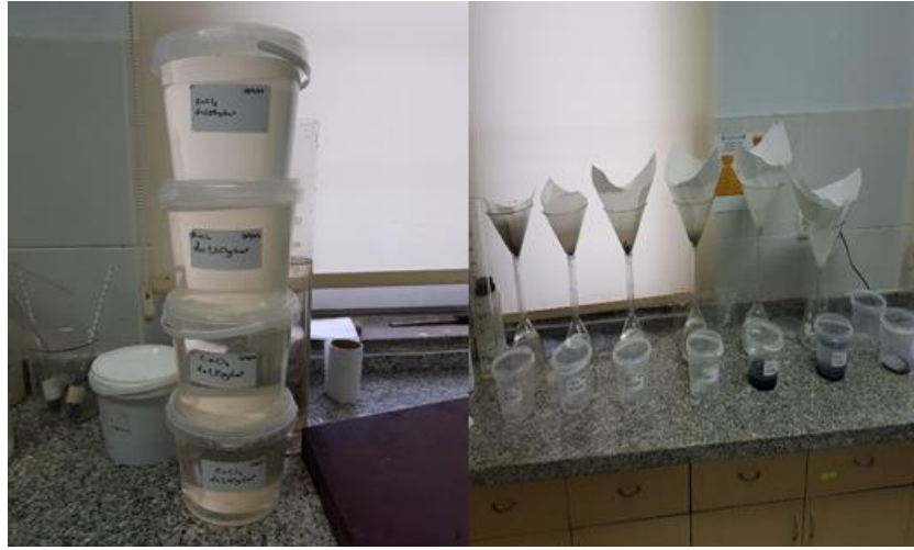
Şekil 22. Yüzdürme batırma için hazırlanan çözeltiler (soldaki) ve test sonrası malzeme filtreleme işlemi (sağdaki)
