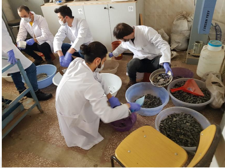
Şekil 11. Ocak önü atığının elekler yardımıyla ayrıştırılması
