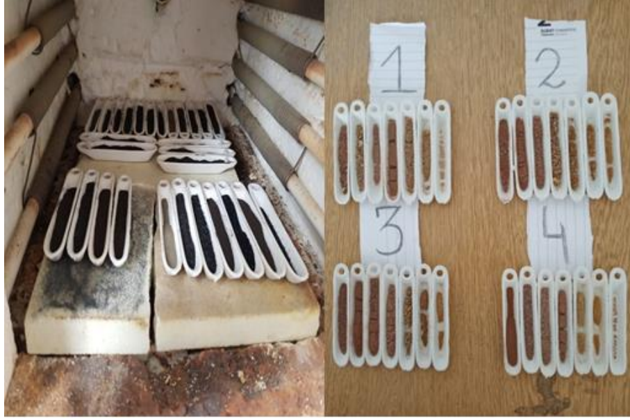
Şekil 25. Kül analizinden önce (soldaki) ve sonra (sağdaki) krozeler içindeki malzeme
