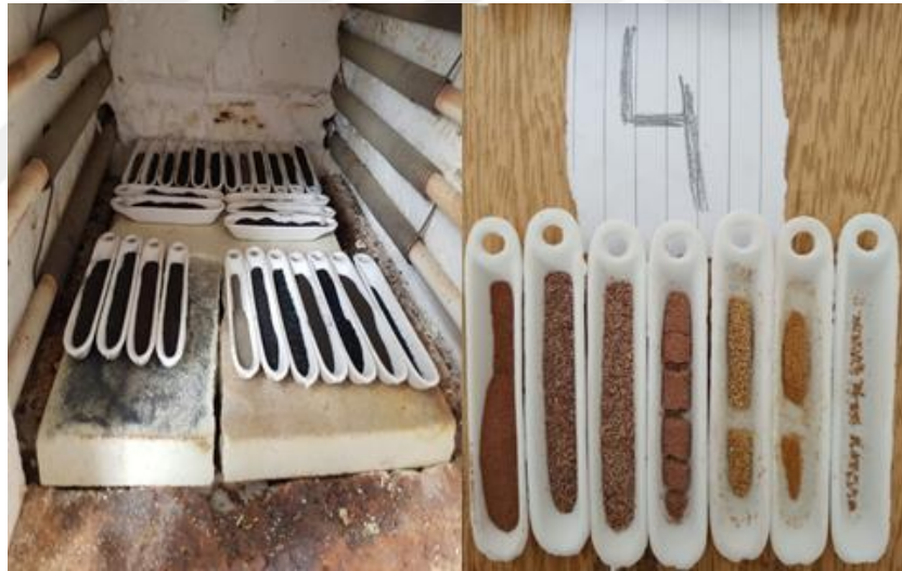
Şekil 9. Kül fırına krezelerle birlikte konulmuş malzeme (solda), yakılmış malzeme ve her krezedeki farklı kül miktarları (sağda)
