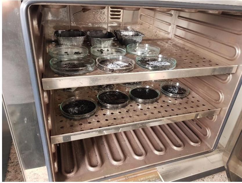
Şekil 24. Yüzdürme batırma testinden sonra kül analizi için kurutulan malzemeler
