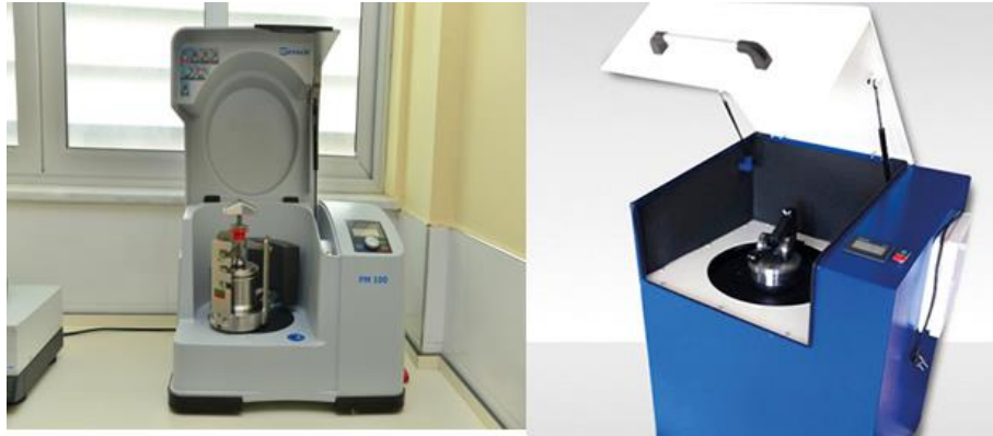
Şekil 18. Malzeme boyutunu küçültmek için kullanılan bilyeli (soldaki) ve halkalı öğütücü (sağdaki)
