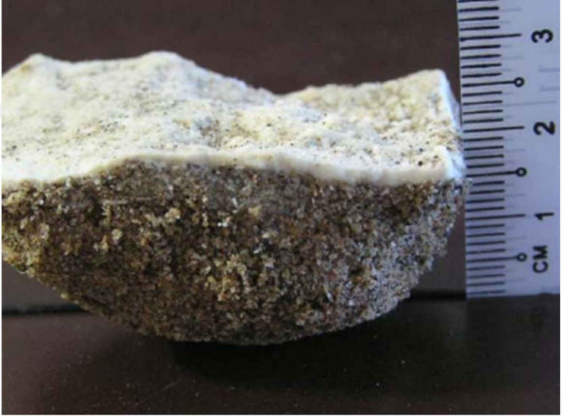
Şekil 2.5. Uygulama yapılan kum yüzeyinde oluşan kabuk (Stabnikov et al. 2011)
