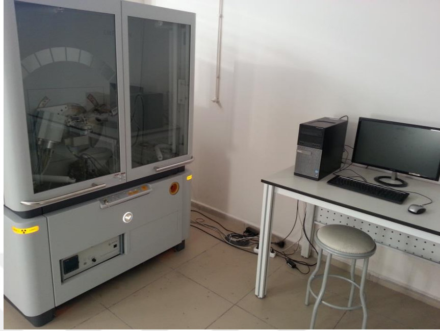
Şekil 3.20. X-ışını kırınım cihazı (Empyrean Series 2 X-ray Diffraction System)
