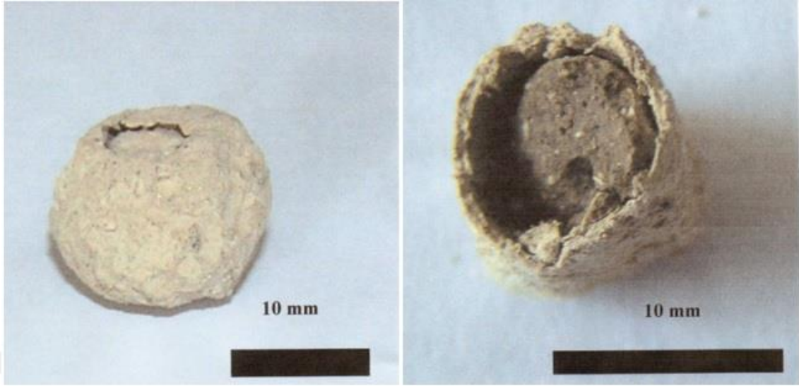
Şekil 2.7. Kil kümesini kaplayan kalsiyum karbonat kabuğu (Ivanov et al. 2015)
