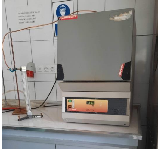
Şekil 10. Piroliz işleminin gerçekleştirildiği fırın
