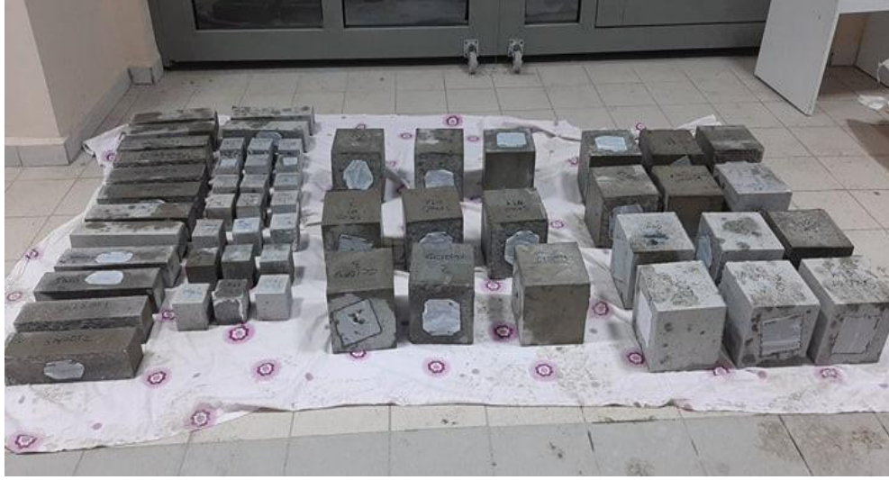
Şekil 31. Kür havuzundan çıkarılan beton numuneleri
