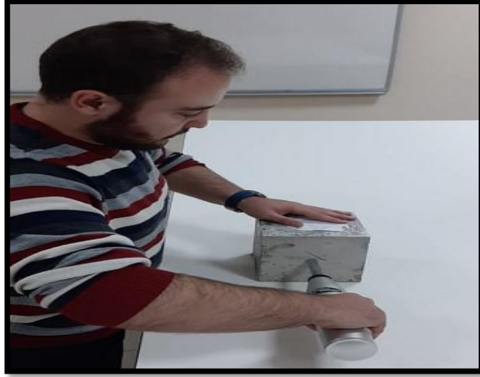
Şekil 23. Test çekici ile geri tepme (Rebound) sayısının belirlenmesi
