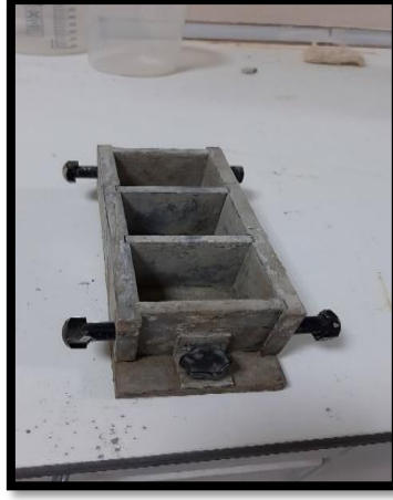
Şekil 33. 50×50×50 mm boyutlu küp numune kalıpları
