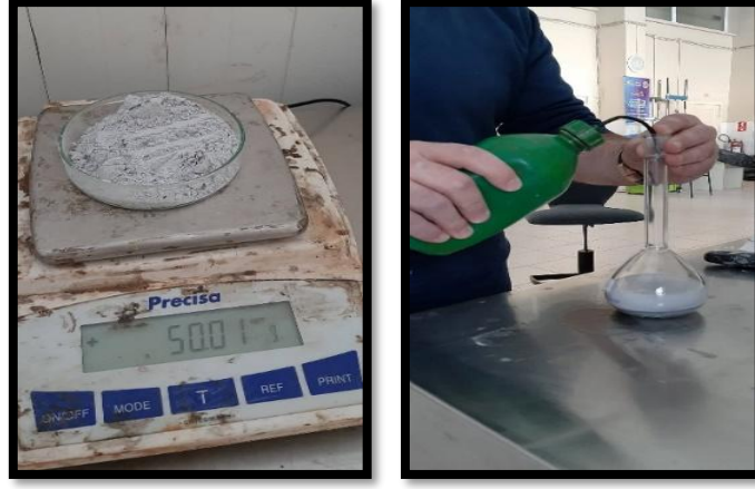
Şekil 27. Obsidiyen tozunun tane yoğunluğunun belirlenmesi
