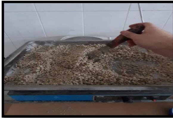
Şekil 24. Seramik atık agregasının ısıtıcı ile doymun kuru yüzey hale getirilmesi
