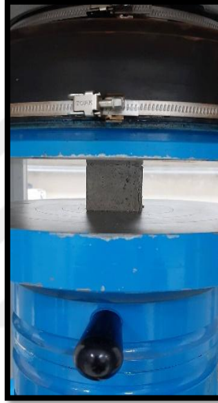
Şekil 37. Kürden çıkarılan harç numunelerinin basınç presinde kırılması
