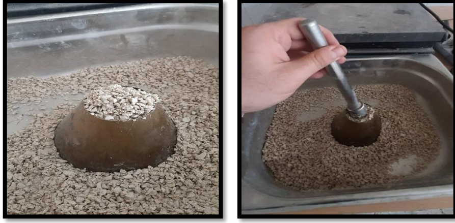
Şekil 25. Koni kalıbın tokmak ile sıkıştırılması
