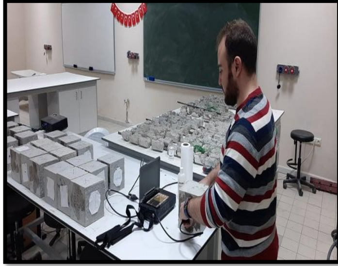
Şekil 21. Ultrases darbe hızının belirlenmesi
