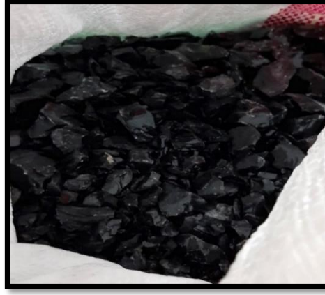
Şekil 14. Kırıcı yardımıyla küçültülmüş obsidiyen
