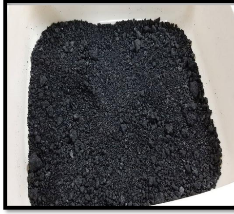
Şekil 12. Agrega boyutunda temin edilen çinko cürufu
