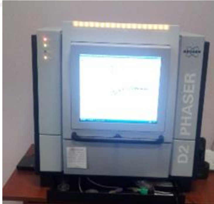
Şekil 2.2. XRD ölçüm cihazı (Bruker D2 Phaser)
