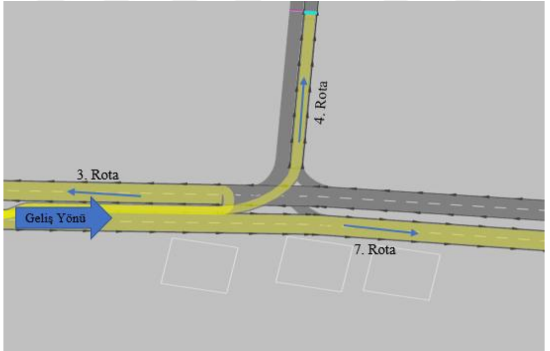
Şekil 35. Belediye önü kavşağına Mobil Kavşağından gelen araçların rotaları
