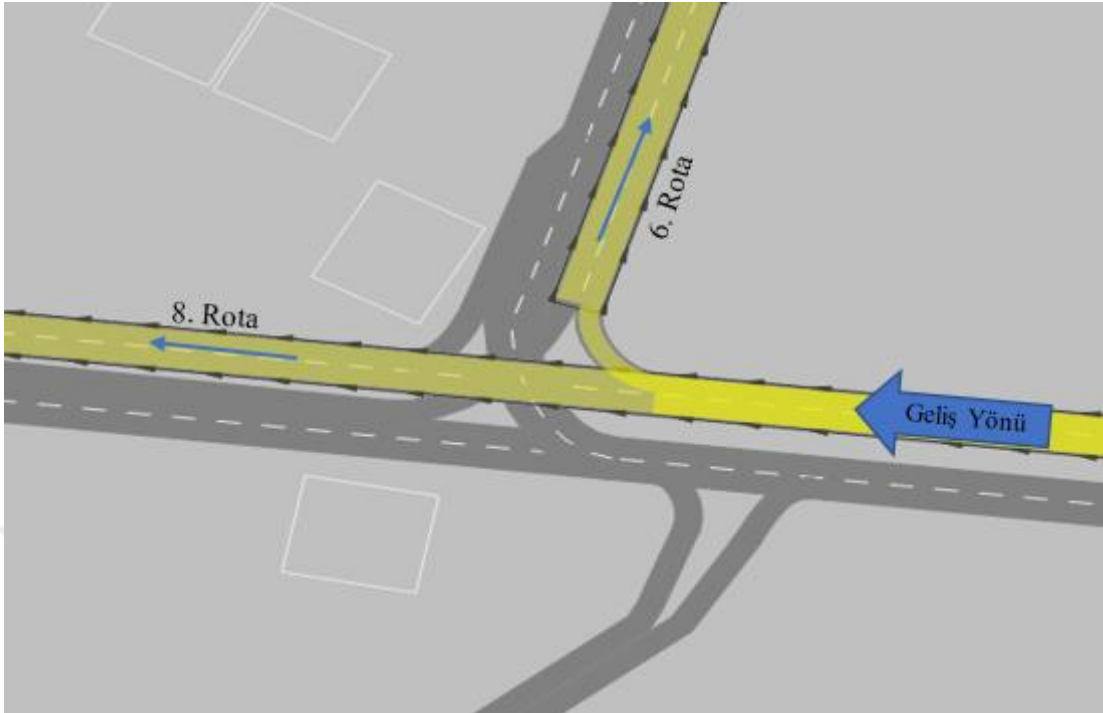
Şekil 30. Donanma kavşağına Mobil Kavşağından gelen araçların rotaları
