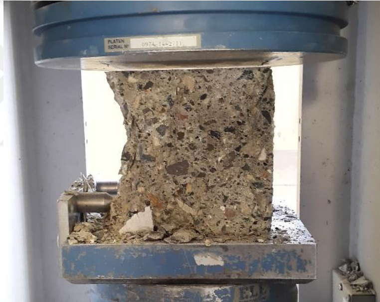
Şekil 21. Basınç dayanımına maruz kalmış küp numune
