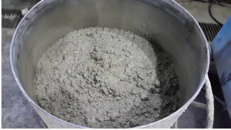
Şekil 20. Beton karışımının betoniyerde karıştırıldıktan sonraki görünümü
