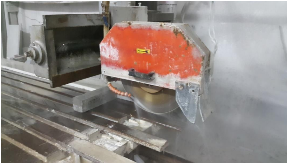
Şekil 23. Prizmatik numunelere mermer testeresi ile çentik açılması
