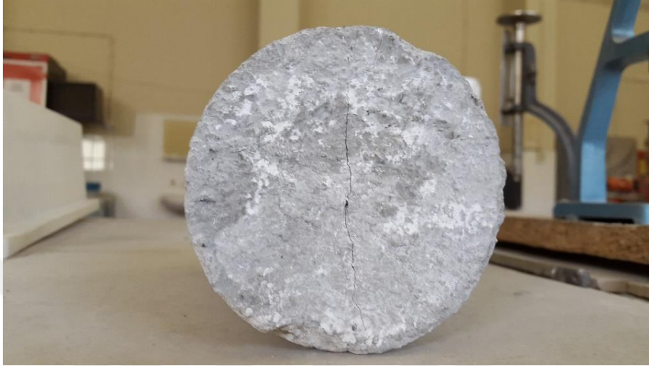
Şekil 22. Yarmada çekme dayanımına maruz kalmış silindir numune
