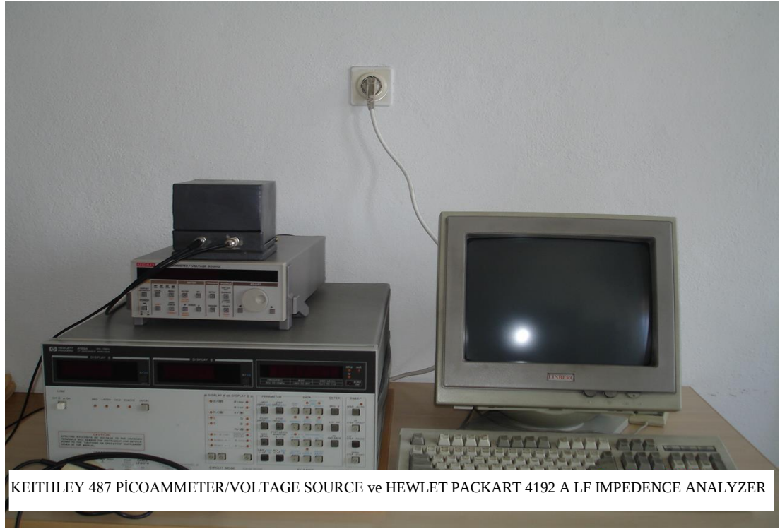
Şekil 3.8. Akım-voltaj ve kapasite-voltaj ölçüm sistemi
