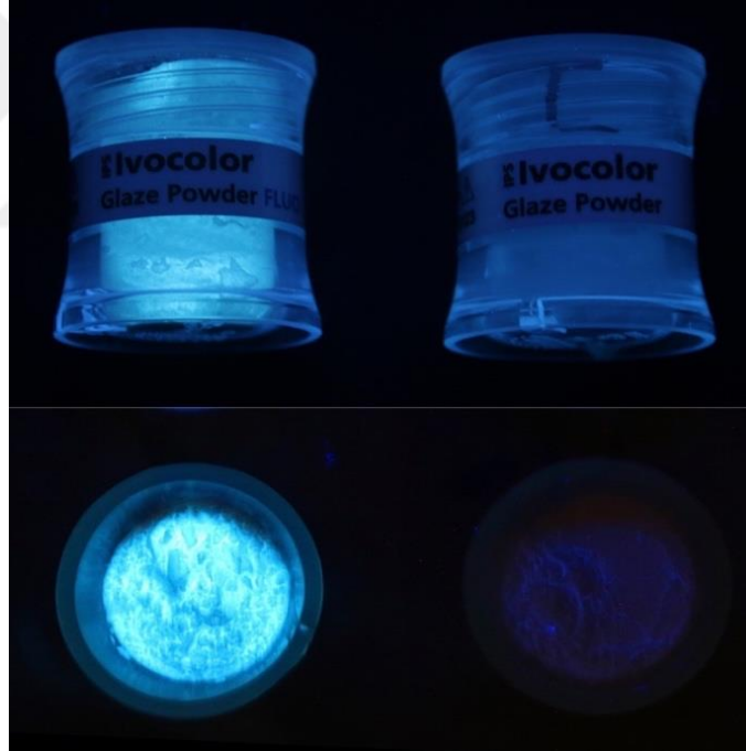
Şekil 3.15. Floresan ve nonfloresan özellikteki glaze tozlarının UV ışığı altındaki görünümü
