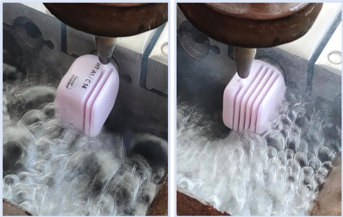
Şekil 3.4. IPS e.max CAD blokların su jet cihazı ile kesimi
