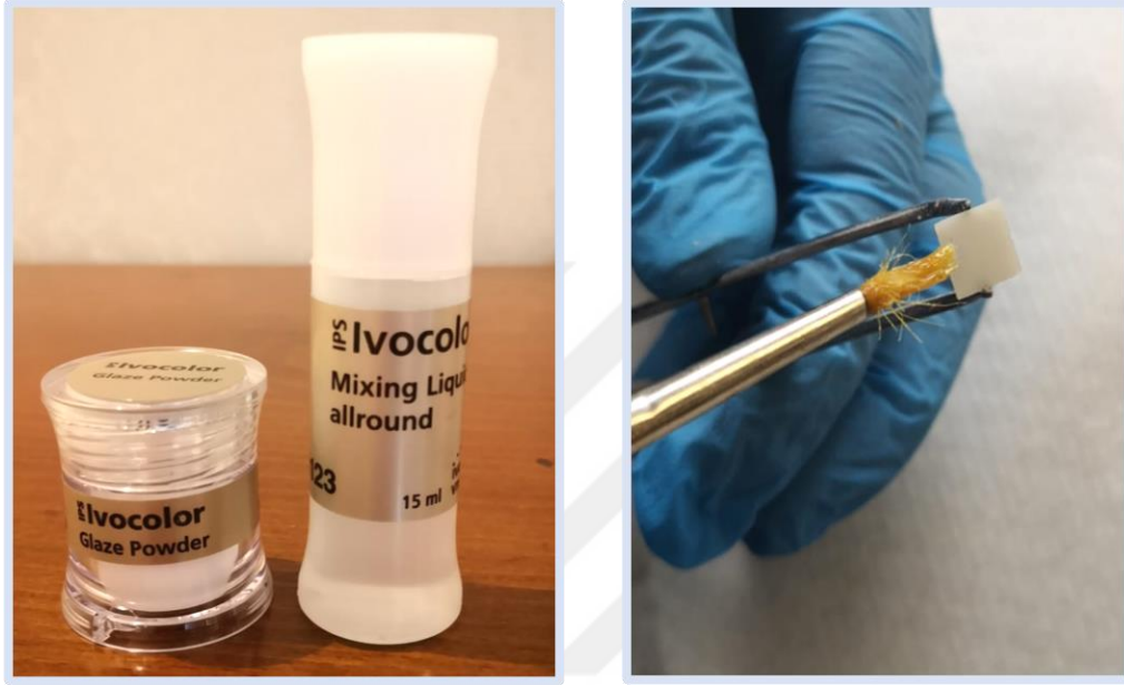
Şekil 3.13. Nonfloresan glaze tozu, likiti ve uygulaması
