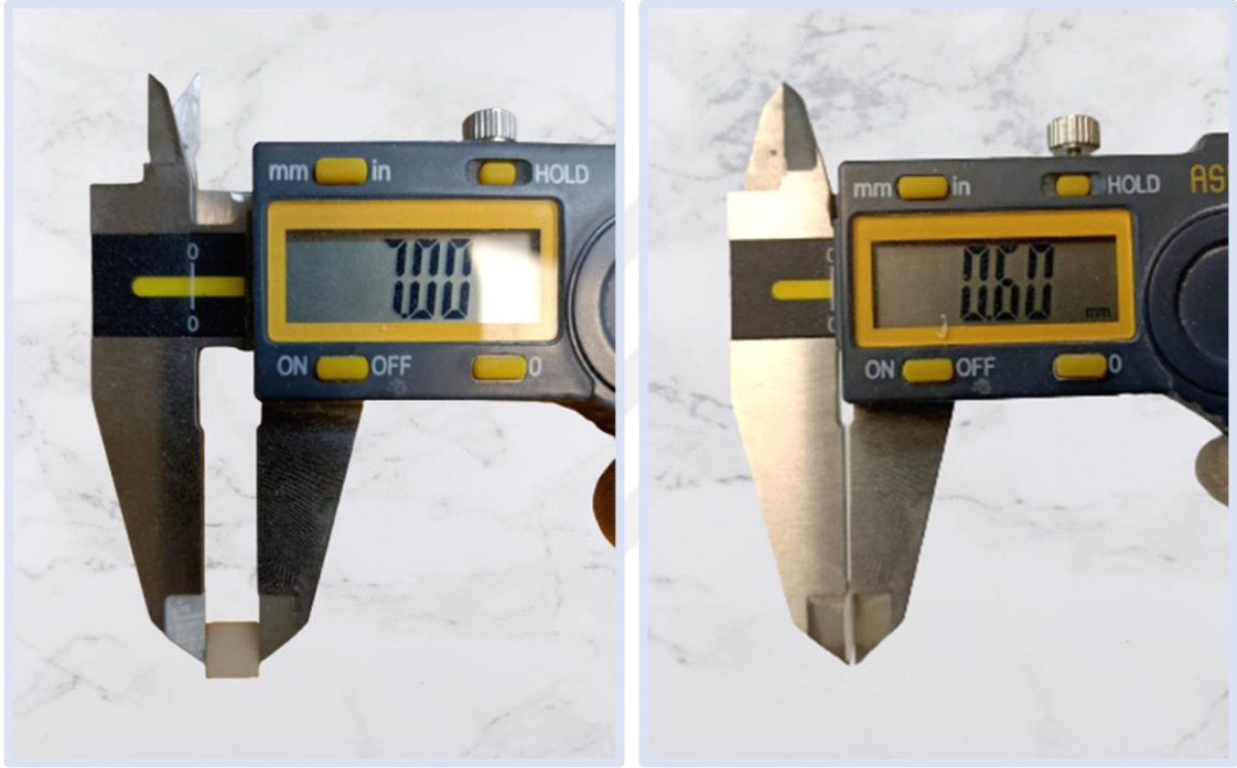
Şekil 3.9. Hazırlanan örneklerin boyutlarının dijital kumpas yardımıyla kontrol edilmesi
