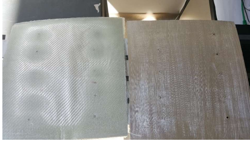
Şekil 3.8. Vakum destekli reçine infüzyonu yöntemiyle üretilen FMT kompozit plakalar
