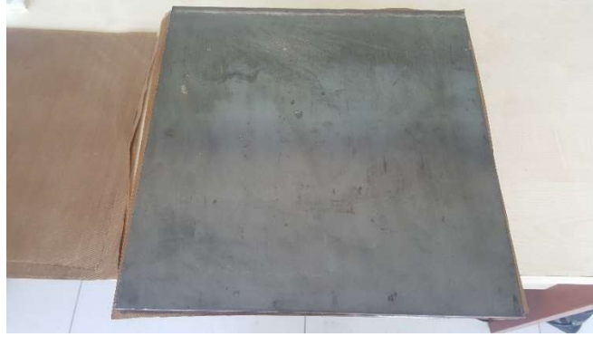
Şekil 3.10. Sıcak pres ile tabakalı kompozit üretiminde kullanılan kalıplar
