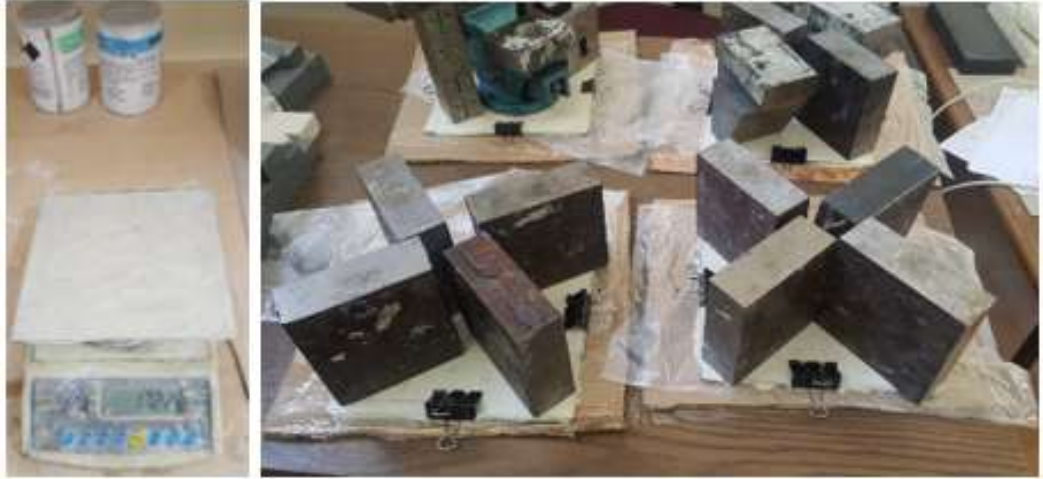
Şekil 3.13. Alüminyum levhaların yapıştırılması ve levhaların üzerine ağırlık konularak kürlenmesi
