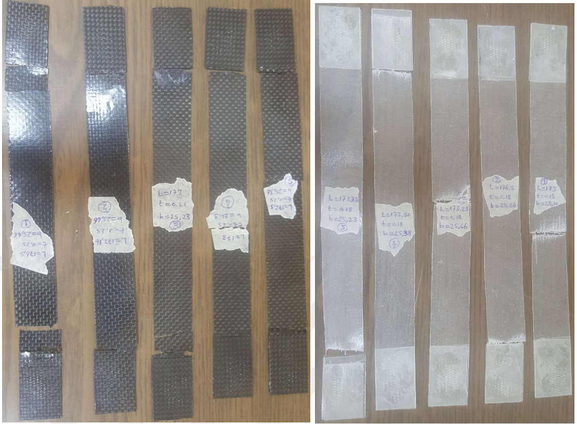
Şekil 3.22. Çekme testi numunelerinin kırılma şekli
