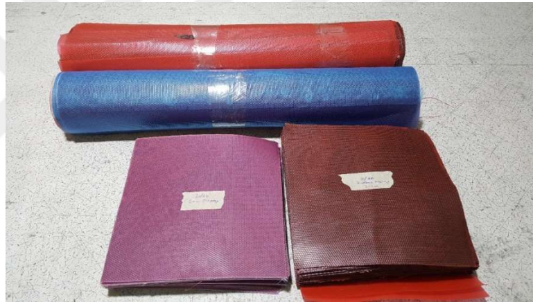
Şekil 3.9. Numune boyutlarında kesilen Plain dokuma karbon ve cam prepregler
