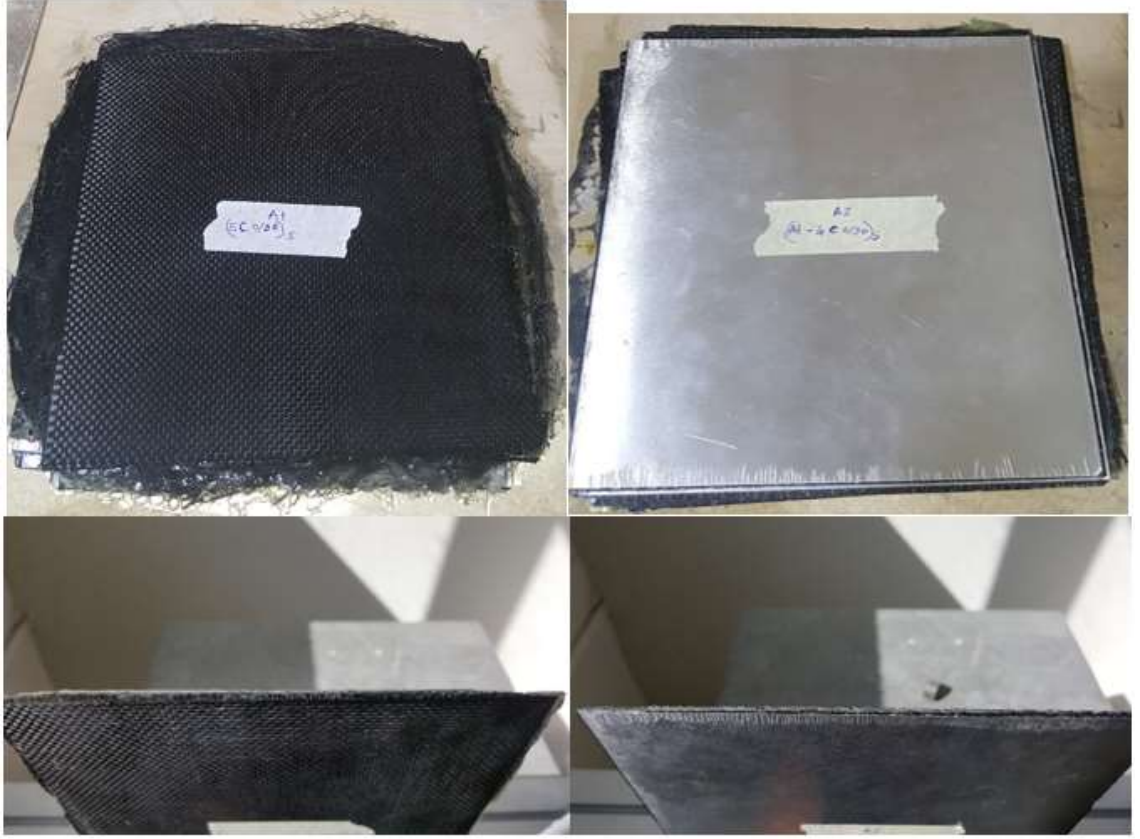
Şekil 3.14. Üretilen CARAL FMT Kompozit Plakalar
