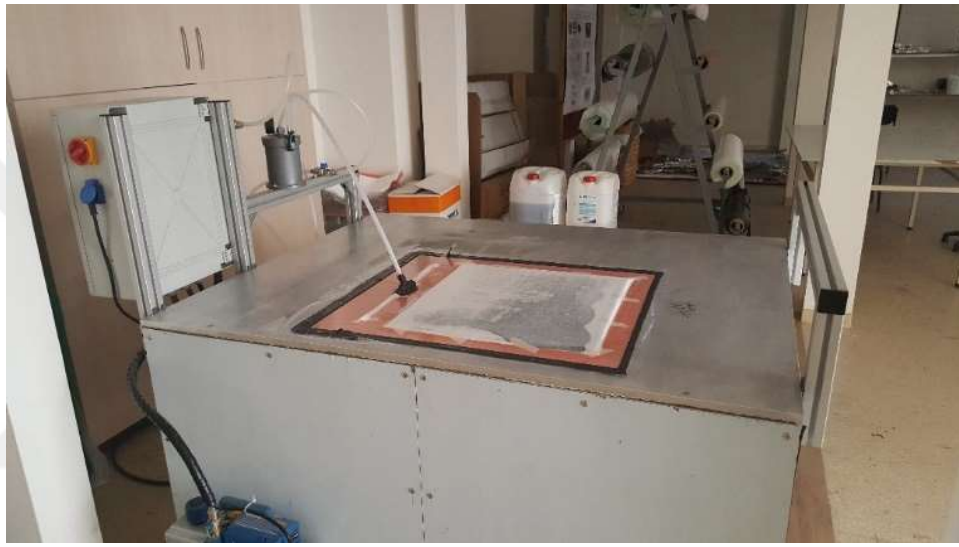
Şekil 3.7. Vakum altına alınmış numune
