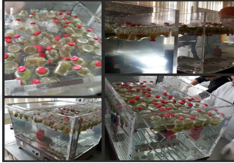
Şekil 10. Cam vialler içerisinde yem örnekleri ve rumen sıvısının su banyosunda inkubasyonu
