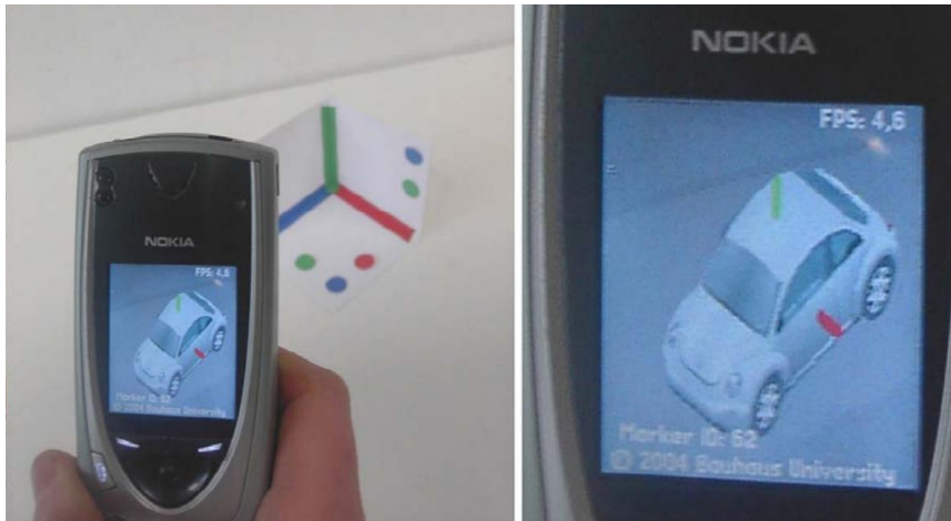
Şekil 7. Cep Telefonlarına Yönelik İlk Video Tabanlı AG Sistemi (Möhring vd., 2004)
