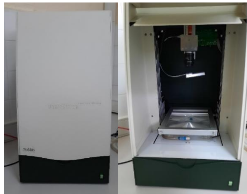
Şekil 4. Zebra balığı ( Danio rerio ) davranış analiz cihazı DanioVision (Noldus Co.)
